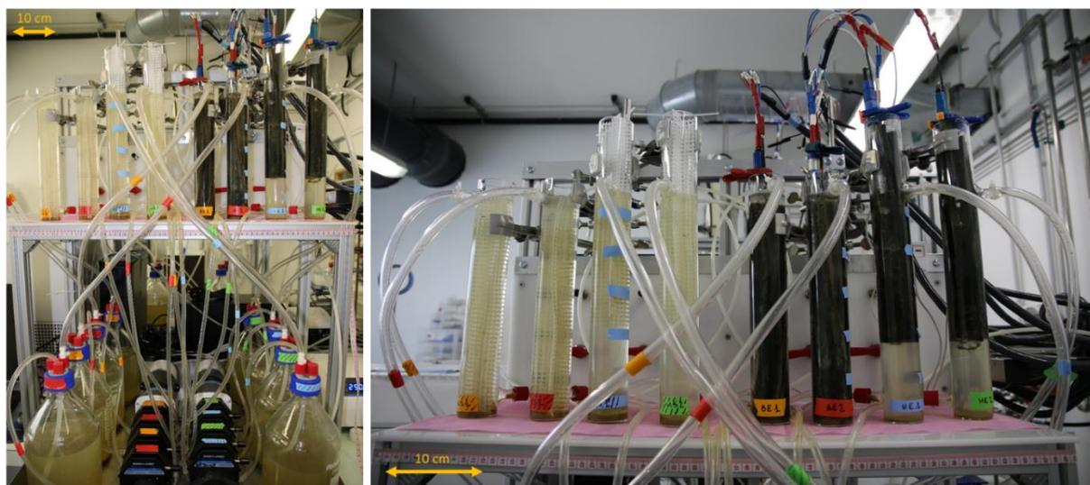
Figure 2.5 : Photographies du montage expérimental, (à gauche) le montage complet en recirculation et (à droite) un zoom sur les réacteurs Biotuba\_26.
