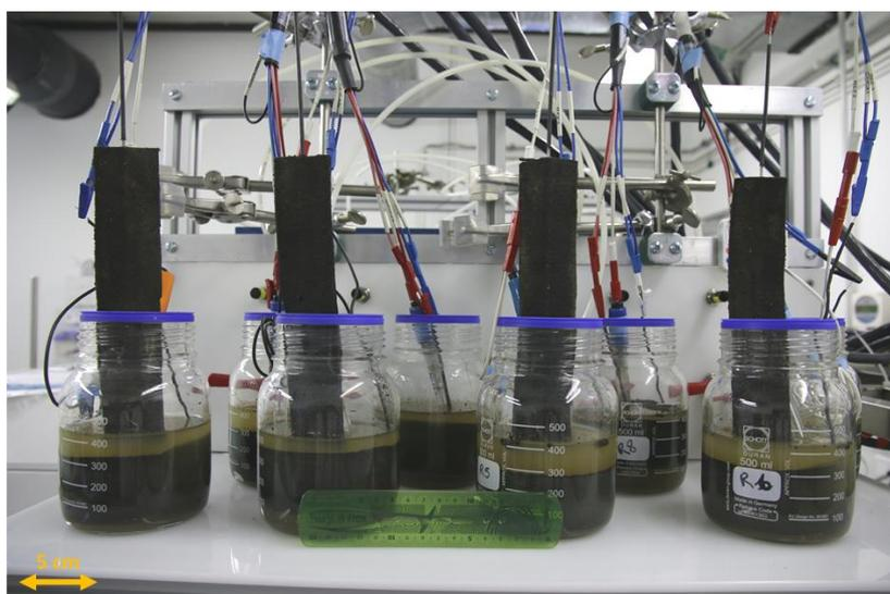
Figure 2.2 : Photographie du montage d'électrodes capillaires émergées 1 (partie 2.1.4 de ce chapitre) dans des réacteurs « standards » en batch.
