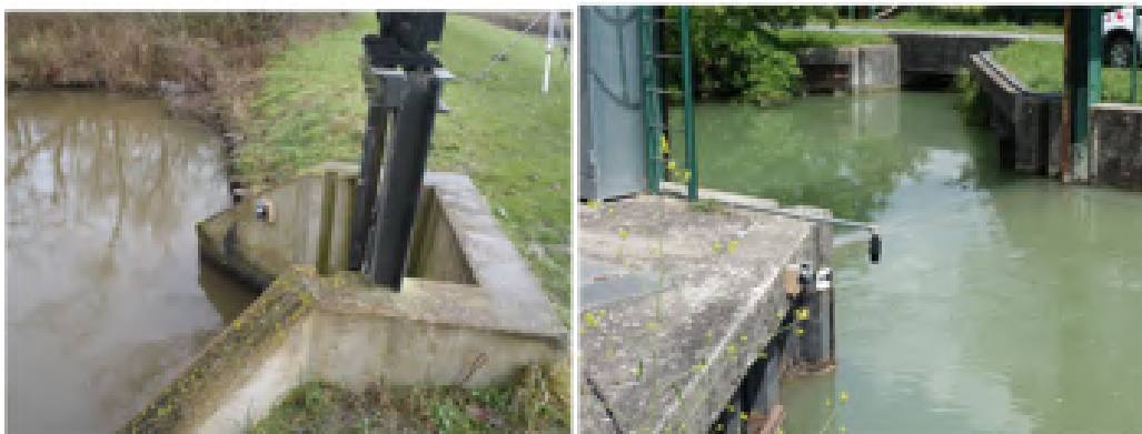
FIGURE 2.9 – Photos des sondes des mesures de hauteur d'eau.
