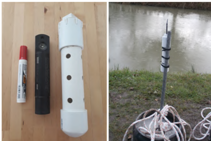
FIGURE 2.11 – Photos : enregistreur conductimétrie avec protection (à gauche) et enregistreur attaché a une tige prise dans un leste (à droite).
