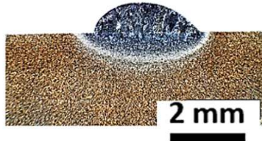
Figure III-38 – Paramètres procédé et principales caractéristiques des monocordons sélectionnés pour la construction de murs larges
