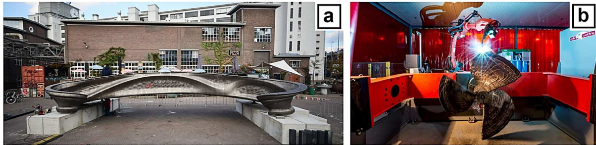
Figure I-11 – Pont de l'entreprise MX3D (a) et hélice de navire RAMLAB (b) imprimés en WAAM
