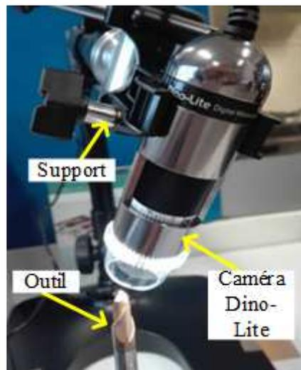
Figure 4. 14. Caméra de mesure d'usure Dino-lite
