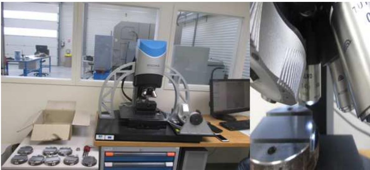
Figure 4. 15. Machine de mesure InfiniteFocus Alicona.
