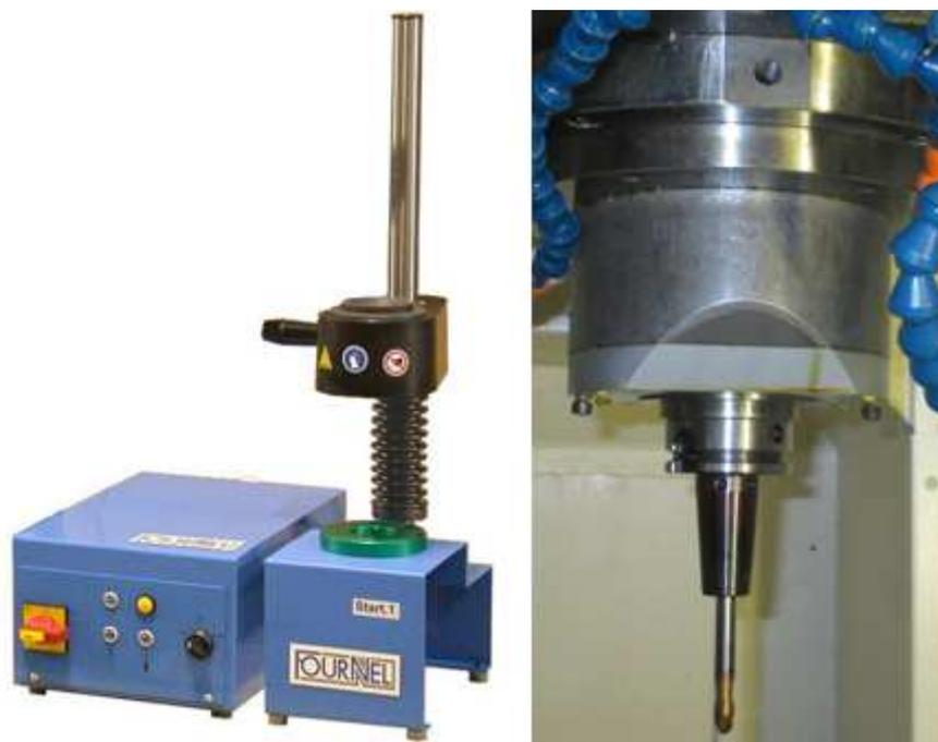
Figure 4. 6. Montage de l'outil par frettage
