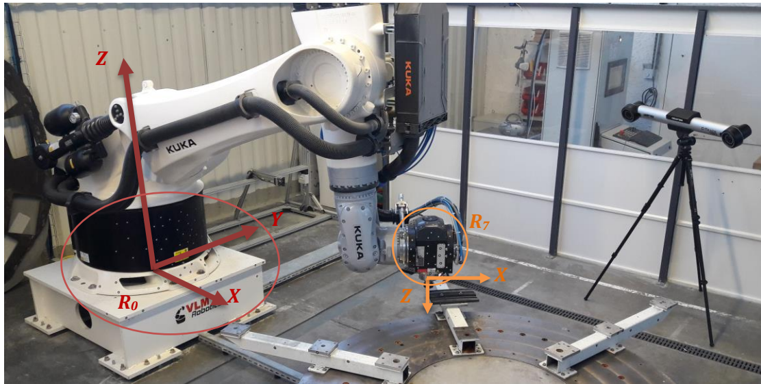
Figure 2-14 : Principe du suivi optique
