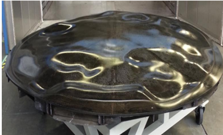
Figure 1-2 : Moule de réflecteur - Composite Carbone / Epoxy
