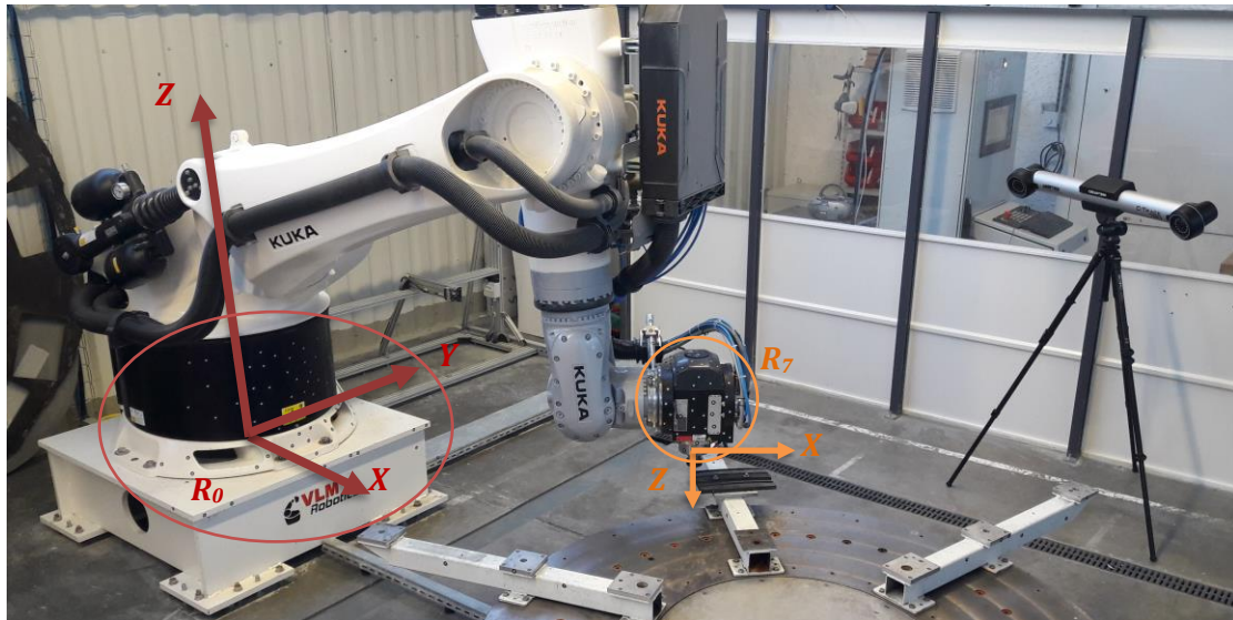
Figure 2-14 : Principe du suivi optique
