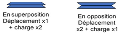
Figure 111 : Schéma empilement des rondelles belleville
