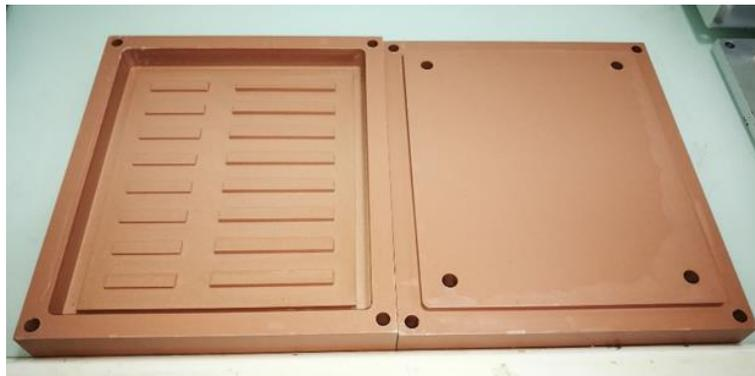
Figure 108 : Photographie du master pour les éprouvettes de Choc Charpy et torsion rectangulaire
