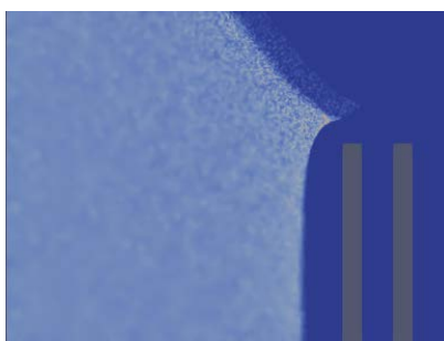
FIGURE 6.13 – Zoom sur l'intérieur de l'injecteur principal du brûleur pour la modélisation de la flamme 2D aluminium-air (points blancs : présence de la phase dispersée dans la maille.)
