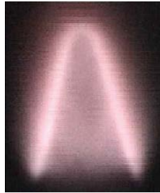
FIGURE 1.4 – Image d'une flamme aluminium-air de type « bec Bunsen » (image extraite de [52])
