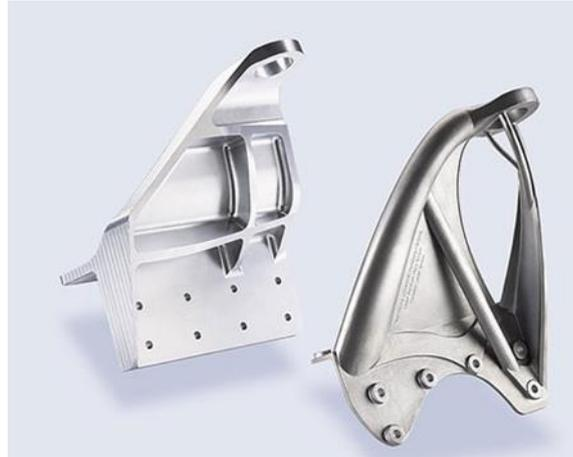
Figure 1 Optimisation topologique d'une patte de fixation en TA6V usiné (gauche) et par FA (droite) permettant un gain de masse de 40 % [6].
