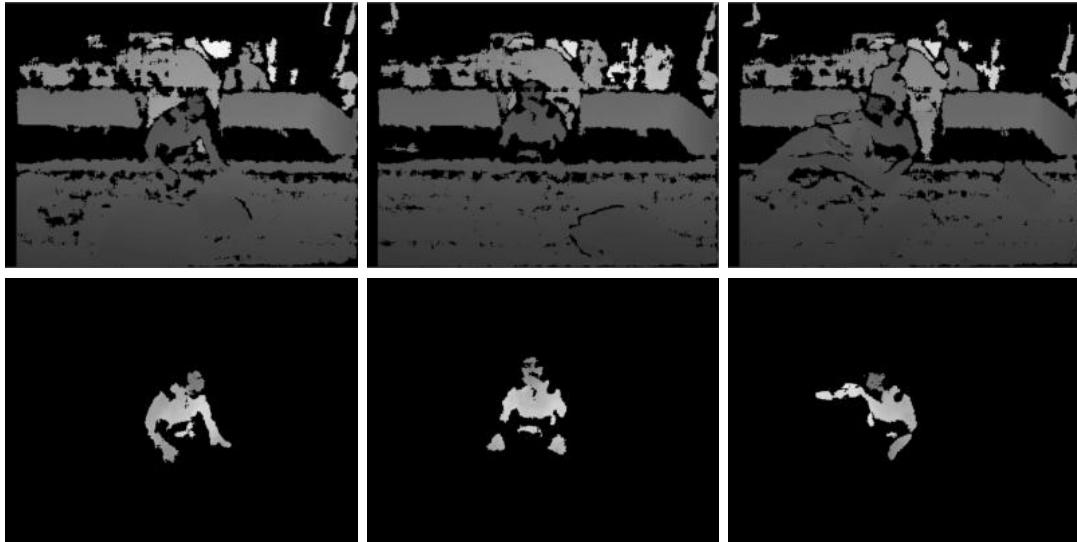
FIGURE 4.3 – Exemple d’images de notre jeu de données (ligne du haut) et de leur segmentation de vérité terrain associée (ligne du bas). La segmentation de l’opérateur humain sur ces images est difficile en raison des contraintes de l’environnement industriel et de la nature bruitée des images de profondeur.
