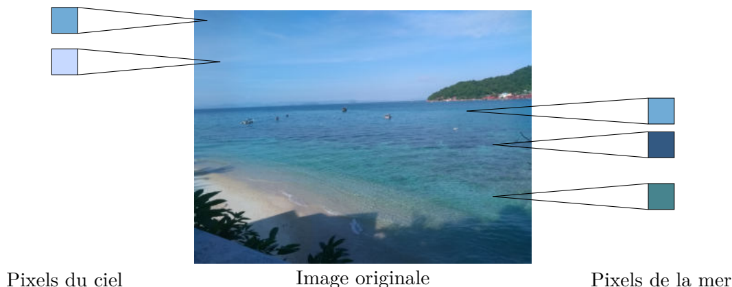
FIGURE 3.10 – Exemple d'image où l'information globale est importante pour construire une segmentation sémantique. En effet, certains pixels du ciel et de la mer ont la même couleur, alors que d'autres, appartenant pourtant à la même classe, ont des couleurs très différentes. Pour les distinguer, il faut donc ajouter à cette information locale une information plus globale.
