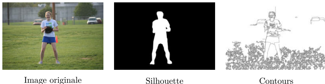
FIGURE 3.13 – Exemples de caractéristiques de bas niveau. À gauche, on a l'image originale. Au milieu, on a extrait la silhouette de l'individu, et à droite, on a extrait les contours de l'image.
