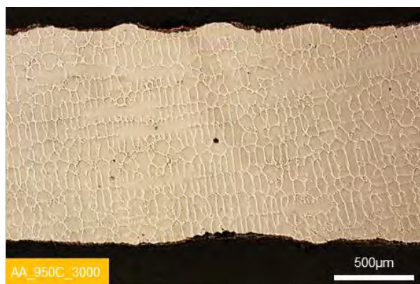
Figure 219 : Observation de la section transverse d'un coupon après 3000 cycles à 950°C au microscope optique
