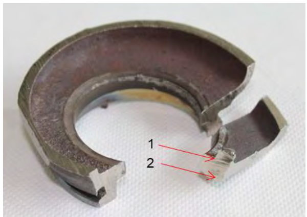
Figure 275 : Localisation des fissures 1 et 2 observées sur la volute
