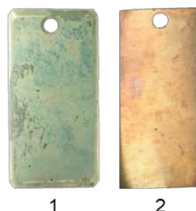
Figure 187 : Courbes de gain de masse en fonction du temps obtenues par thermogravimétrie sur des coupons d'acier W.Nr. 1.4826Nb à 700°C sous air + 5%Vol H 2 O (gauche) et apparence des coupons après refroidissement (haut). Le début de l'oxydation catastrophique est indiqué par une flèche.
