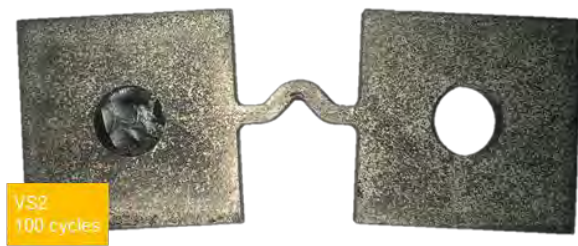
Figure 267 : Déformée de l'éprouvette observée lors du démontage après 100 cycles entre 300 et 950°C
