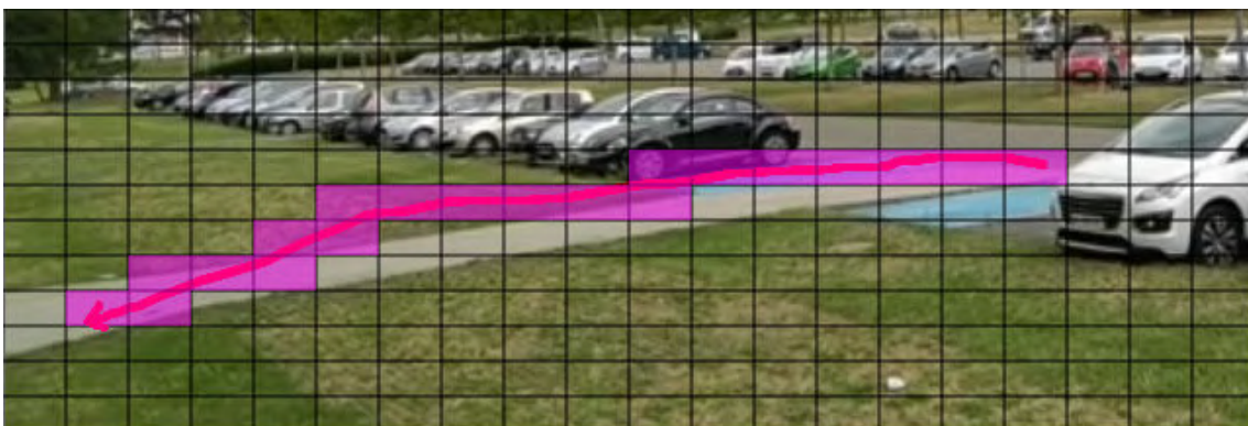
FIGURE 5.15 – Exemple de trajectoire requête et de cellules traversées – en rouge, une trajectoire requête dessinée dans une vue par l'utilisateur. Les cellules traversées par cette requête sont mises en évidence en rose. C'est à partir des cartes de correspondance entre ces cellules et une autre vue que nous reformulons la trajectoire.
