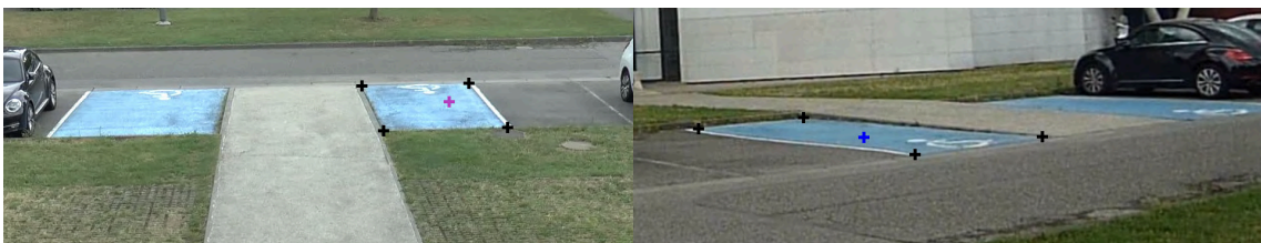
FIGURE B.1 – Une homographie entre deux ensembles de points — Les quatre coins d'une place de parking sont visibles dans les vues des deux caméras. L'homographie est estimée à partir des correspondances entre les quatre coins de la place de parking, représentés par des croix noires. Pour un autre point de la vue de gauche, en violet, l'homographie permet alors d'obtenir automatiquement son correspondant dans la vue de droite, en bleu.
