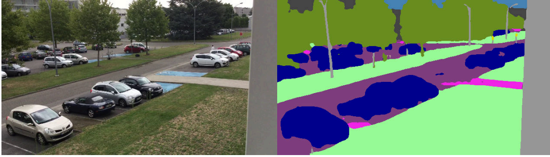
FIGURE 2.11 – Segmentation sémantique d’une image par l’algorithme de [Zhu 19] — À gauche, une image issue du jeu de données que nous avons proposé et que nous présentons au chapitre 3. À droite, la segmentation sémantique de cette image, chaque couleur correspondant à un type de décor : la route apparaît en mauve, les zones piétons en rose, l’herbe en vert pâle, la végétation en vert foncé, les bâtiments en gris et les véhicules en bleu.
