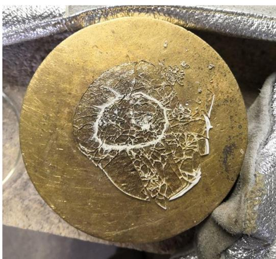
Figure VI.1 : Photographie du matériau G-0X0 obtenu sur une plaque de cuivre, après l'étape de trempage entre deux plaques de cuivre.
