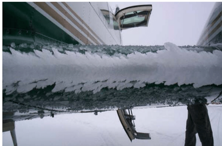
FIGURE 1. – Accumulation de givre sur le bord d'attaque d'une aile (ONERA).
