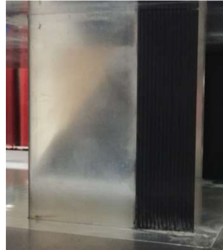
FIGURE 4.3. – Bord de fuite collé à un mât de la maquette.
