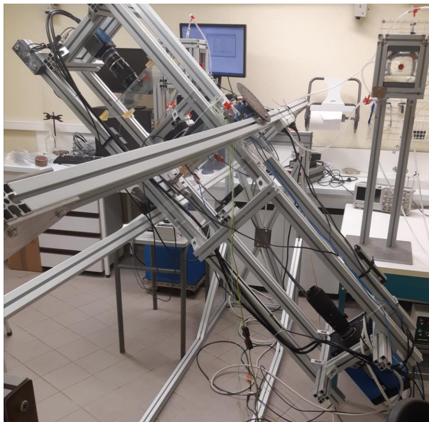
Figure O-4 Montage expérimental pour une rotation \alpha=180^\circ , \theta=-45^\circ
