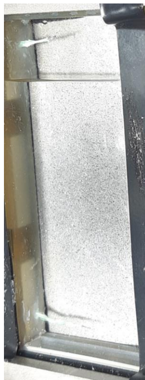
Figure III-20 État final dans le cas évaporateur avec sortie vapeur vers le haut, côté cœur de l'évaporateur, mèche en aluminium
