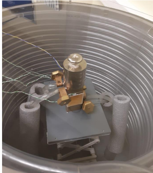
Figure H-3 Dispositif de mesure de la conductivité thermique de la résine
