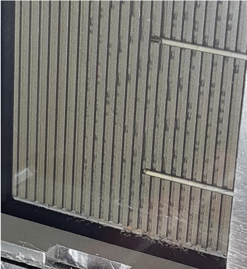
Figure III-56 Génération de vapeur à l'extérieur de la mèche dans le cas évaporateur avec sortie vapeur vers le bas, mèche en acier
