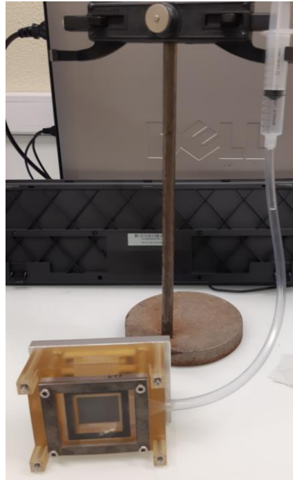
Figure G-8 Test d'étanchéité par application d'une pression via une seringue
