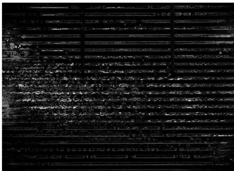
Figure III-47 Invasion dans le cas évaporateur à plat, côté canaux vapeur, mèche en acier (8)
