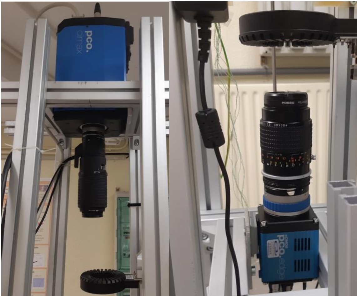
Figure II-39 À gauche : caméra rapide PCO DIMAX S4 ; à droite : caméra PCO Edge sCMOS 5.5.
