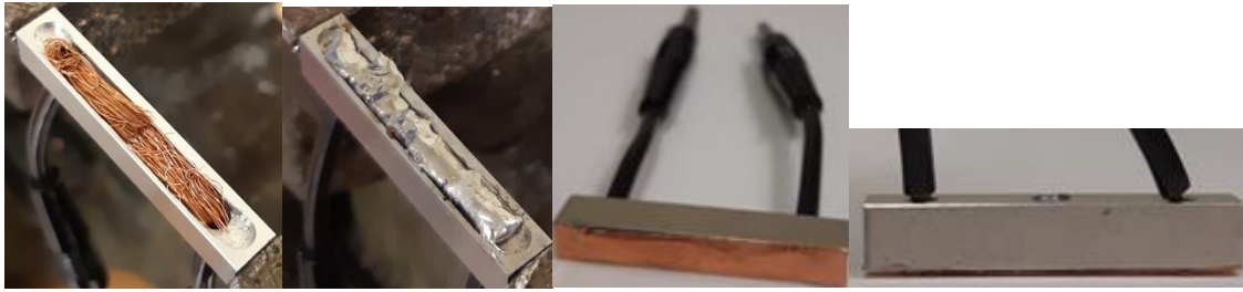
Figure I-12 Premier concept de contact électrique. De gauche à droite : disposition des fils de cuivre dans la gorge, étain coulé, disposition d'une bande de cuivre sur l'étain poli, vérification de la planéité.
