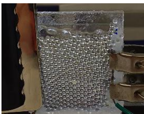
Figure G-1 Test de transparence et de chauffe dans une cellule de Hele-Shaw
