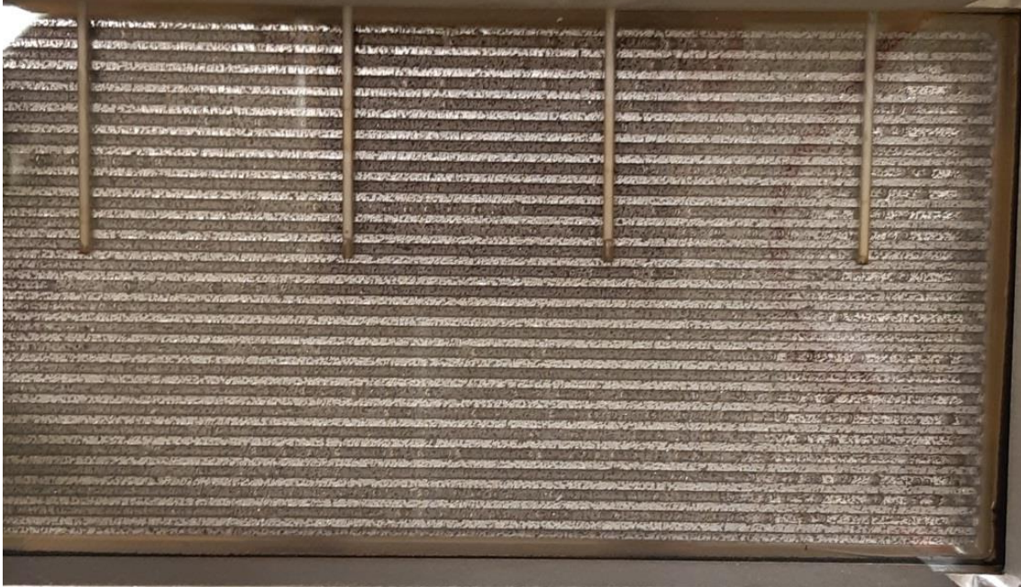
Figure II-27 Visualisation de l'apparition de vapeur dans les rainures pour la mèche en aluminium
