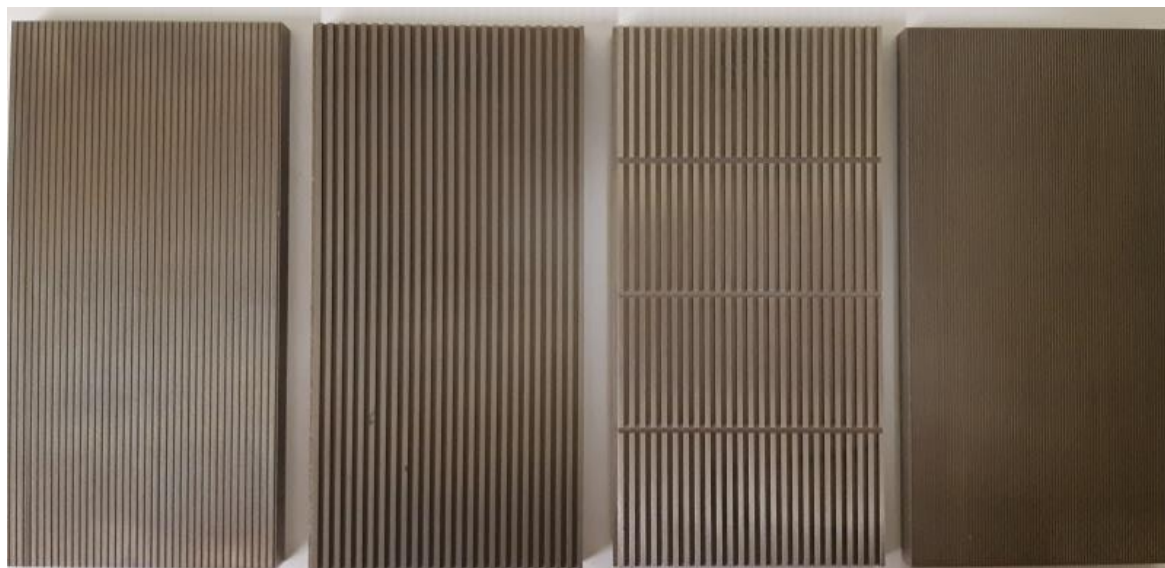
Figure II-23 Différentes rainures réalisées par électroérosion (de gauche à droite, numéro 2,1,4,3)
