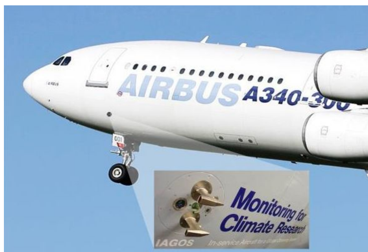
Figure 2.1 – Illustration d'un Airbus A340 équipé des instruments de mesures IAGOS. On voit sur le zoom les modifications apportées à la carlingue pour y installer les prises d'air connectées aux instruments.
