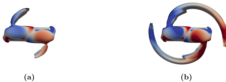
Figure 4.6. – Visualisation du sillage autour d'un cylindre pour \chi = 3 avec le critère Q = 10^{-3} coloré par la vorticité \omega_z allant de -1 à 1 . La visualisation est réalisée dans le plan (x, y) . (a) Re = 60 , (b) Re = 180 .
