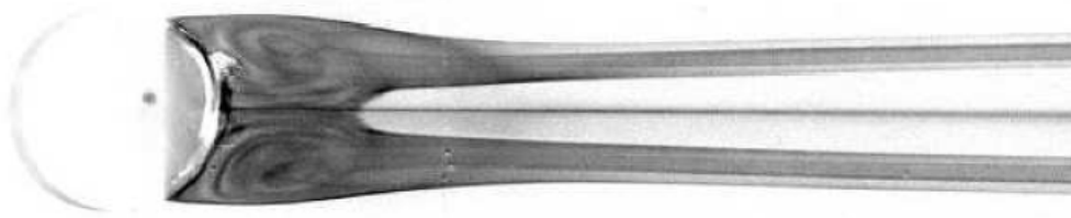
Figure 1.3. – Deux tourbillons contrarotatifs pour Re = 250 (Prządka et al. , 2008).
