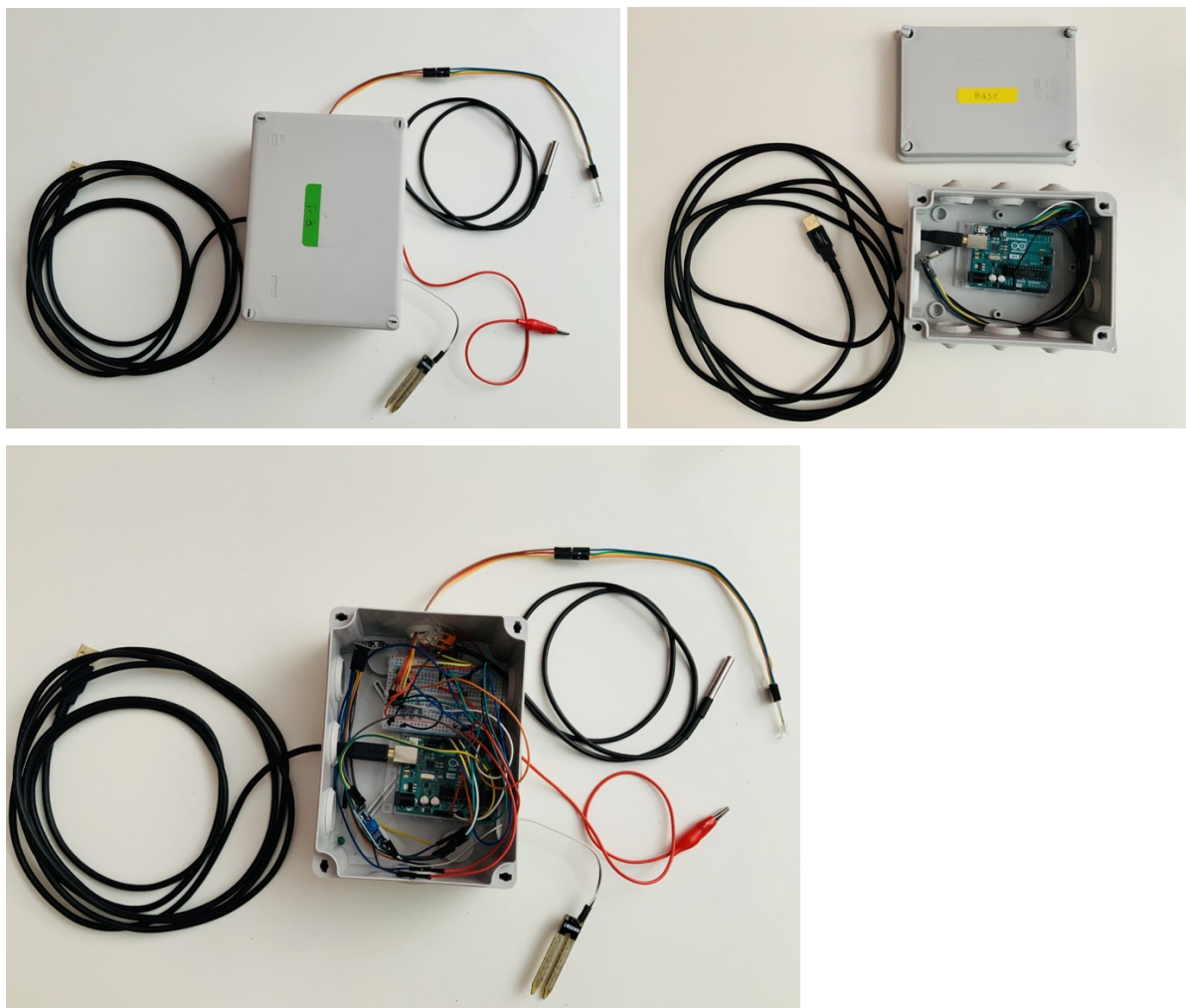
Figure 53 : Circuits électroniques ; en haut à gauche il y a un des un circuits « transmetteurs », en haut à droit, le circuit « base » ou « récepteur », et en bas, une boîte ouverte pour observer le prototype. [Photographies]
