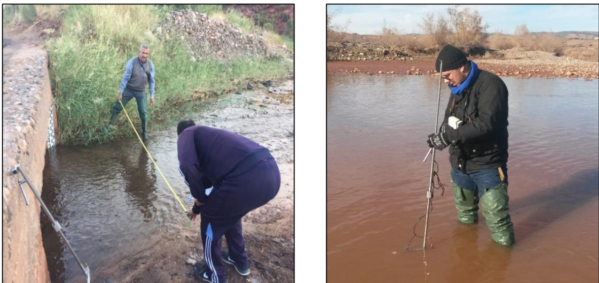
Figure 10-8 : Mesure de la largeur et de la profondeur de la section du cours d'eau
