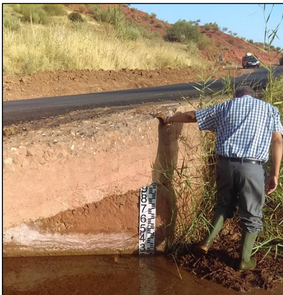
Figure 10-6 : Echelle limnimétrique installée sur l'oued de Srou et sur l'affluent Assif N'douma
