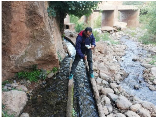
صورة 17: قياس صبيب الساقية باعتماد البكرة الدقيقة (عمل ميداني، 2019)
