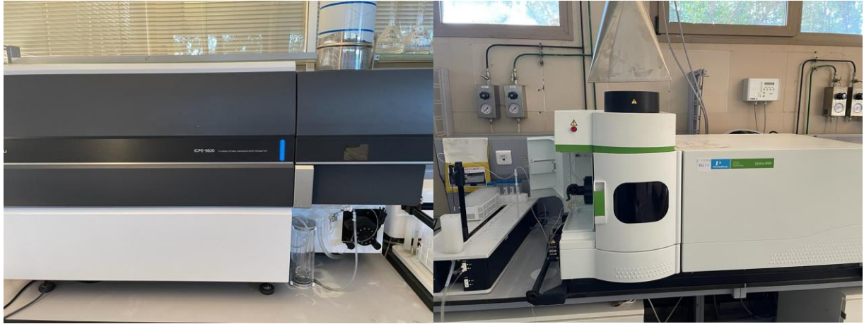
صورة 20: مطياف الكتلة البلازمية المقرونة بالحث (ICP-MS)
