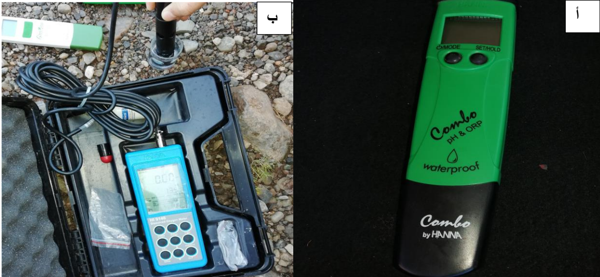
صورة 19: أجهزة قياس درجة حموضة الماء (PH) (أ) وتركيز الأوكسجين (ب)
