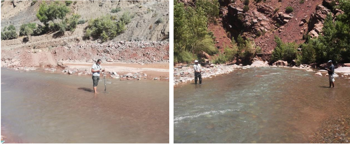
صورة 13: عمليات قياس الصبيب خلال حملات القياس بحوض واد تساوت (عالية سد مولاي يوسف)
