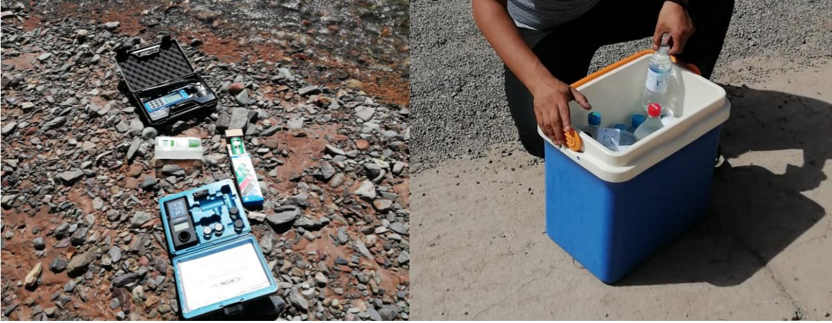
صورة 2: قياس جودة المياه السطحية وأخذ العينات بواد تساوت
