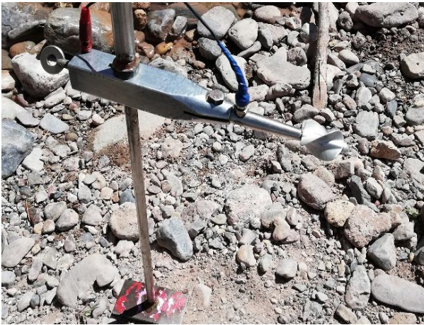
صورة 17: قياس صبيب الساقية باعتماد البكرة الدقيقة (عمل ميداني، 2019)
