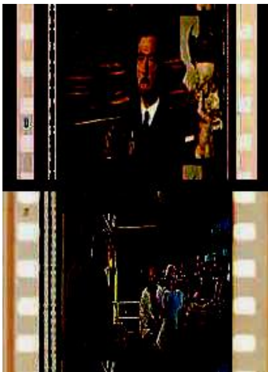
Figure 1.31. : comparaison entre le positif hybride magoptic (en haut : perforations C.S., 4 pistes magnétiques et piste optique de demi-largeur) et le positif à 1 piste optique (et perforations standard K.S., en bas)
