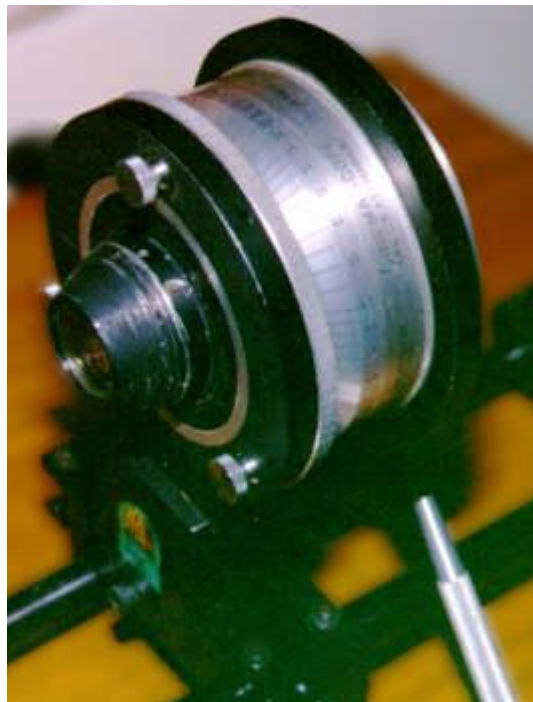
Figure 1.19. : les premiers anamorphoseurs additionnels de Bausch & Lomb pour le CinemaScope Source : www.widescreenmuseum.com/widescreen/wingcs4.htm .
