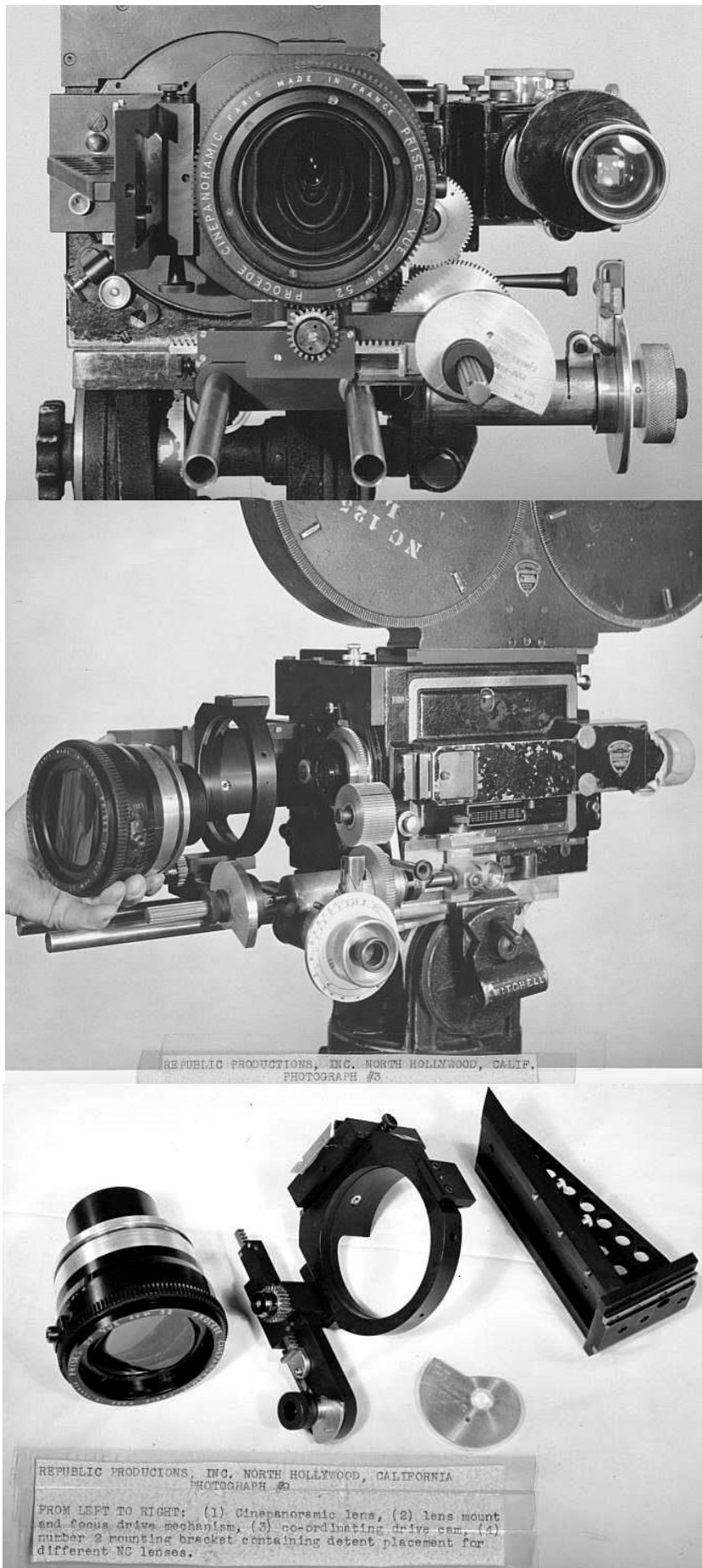
Figures 1.70.a,b&c : procédé américain Naturama : adaptation de l'anamorphoseur P.V. 52 Cinépanoramic mécaniquement couplé au primaire sur une caméra Mitchell NC
