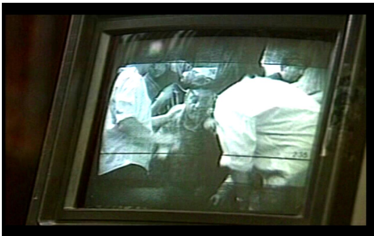
Figure 1.107.c : moniteur vidéo (ou « combo ») présentant un cadrage multiformats : plein cadre 1,33:1 (image filmée intégrale), format 1,85:1 (parties grisées) pour l'exploitation télévisée et repères de cadre pour le 2,35:1 (exploitation en salles) ; photogramme tiré du documentaire « Les Visiteurs revisités », réal. François-Cyril Geroult, supplm. au coffret de DVD Les Visiteurs , Gaumont Vidéo, 2005
