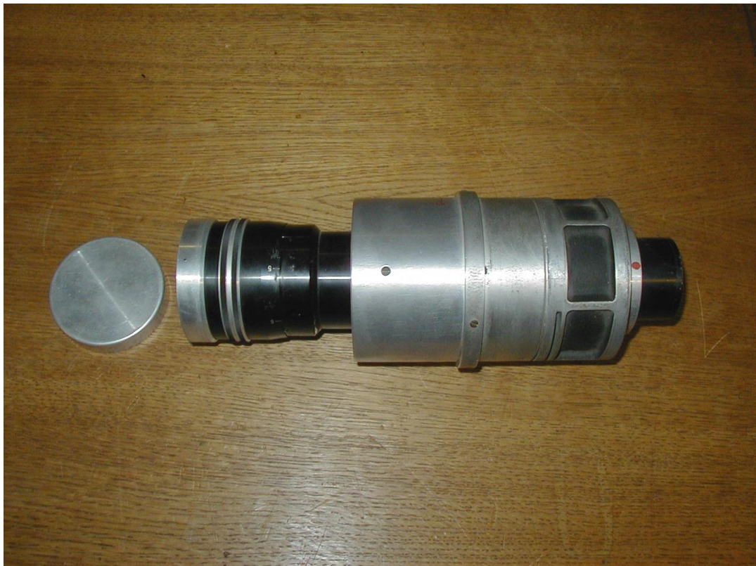
Figures 1.79.c&d : exemplaire d'anamorphoseur de projection Dyaliscope « CHAMPION » pour petites salles standard et salles substandard (16 mm) Collection des Appareils de la Cinémathèque française, clichés personnels
