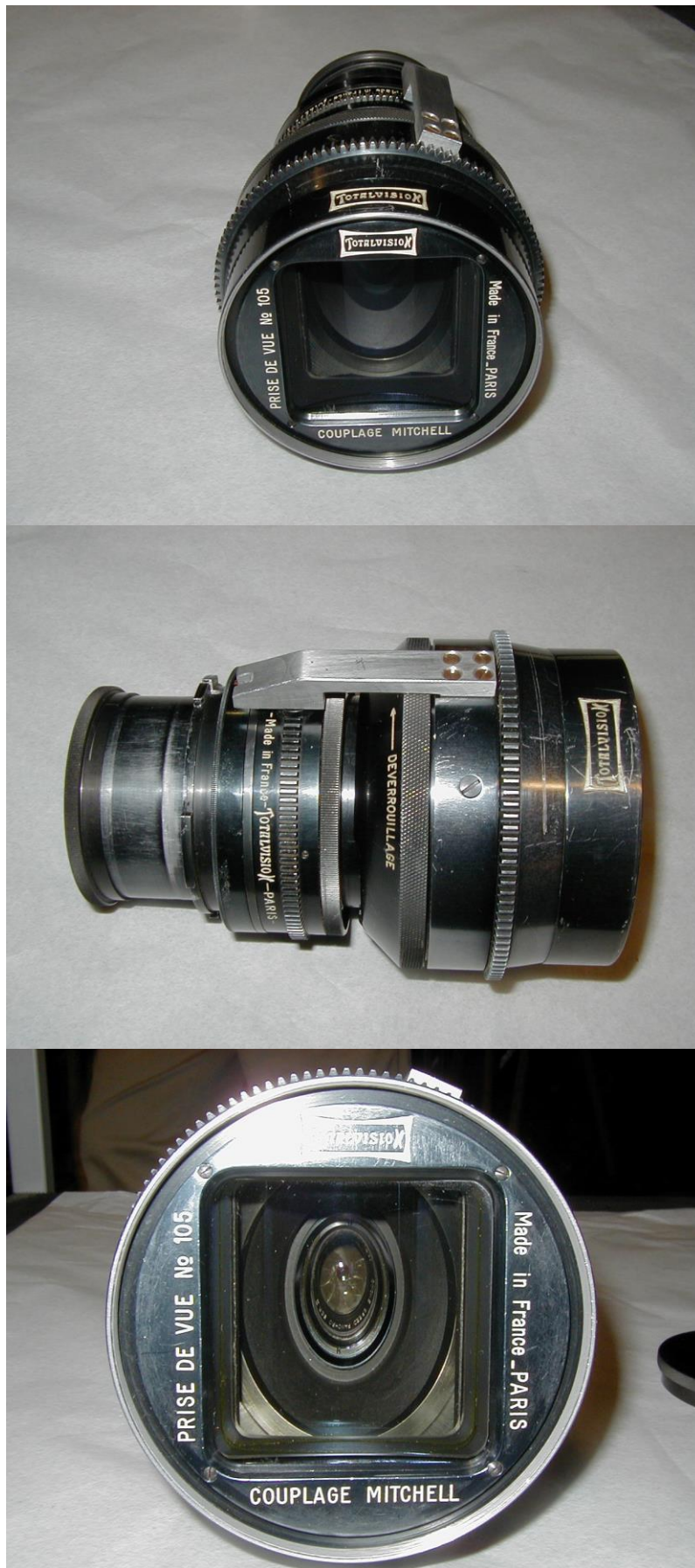
Figures 1.82.b : anamorphoseur de prise de vues Totalvision couplé pour caméra Mitchell, n° 105, conservé par la Collection des Appareils de la Cinémathèque française, clichés personnels
