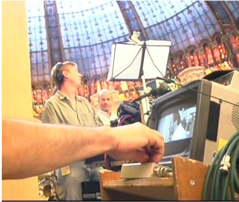
Figure 1.109.a : moniteur de contrôle vidéo avec bandes noires de « gaffer » montrant le cadre en 2,35:1 de la diffusion en salles ; photogramme tiré du « Making of » du film L'Art (délicat) de la séduction (2000 S35 CLR FJ, Richard Berry, D.P. Dominique Bouilleret)
