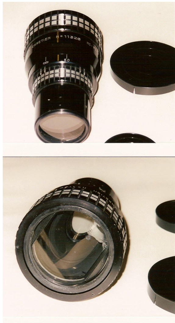
Figures 1.13.a&b : photographies de l'Hypergonar Chrétien n° 11326 (faces arrière & avant) Source : Cinémathèque française, Collection des Appareils
