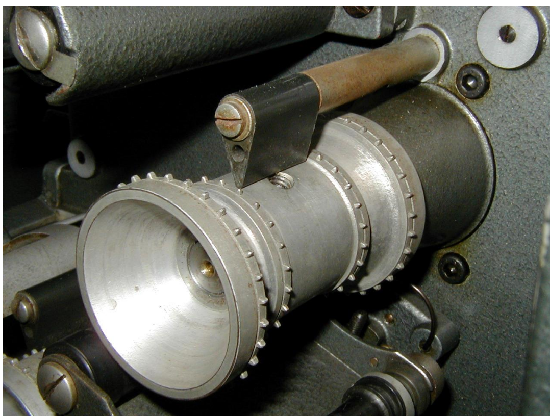
Figures 1.130.c&d : détails du projecteur : en haut, porte du lecteur sonore avec schéma et indications de réglage en italien ; en bas, tambour denté du projecteur bistandard montrant le double mécanisme d'entraînement des copies 35 mm et 70 mm
