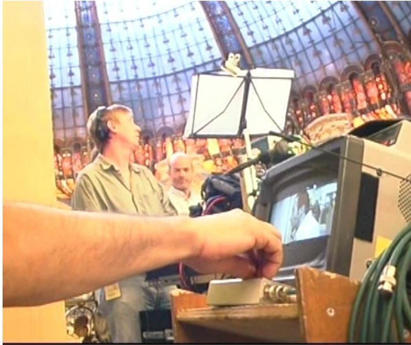
**Figure 1.109.a : moniteur de contrôle vidéo avec bandes noires de « gaffer » montrant le cadre en 2,35:1 de la diffusion en salles ; photogramme tiré du « Making of » du film *L'Art (délicat) de la séduction* (2000 S35 CLR FJ, Richard Berry, D.P. Dominique Bouilleret)**
