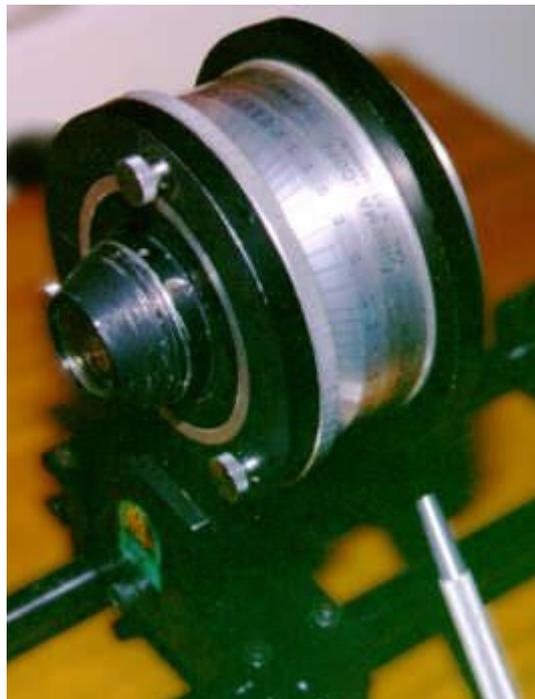
**Figure 1.19. : les premiers anamorphoseurs additionnels de Bausch & Lomb pour le CinemaScope**
