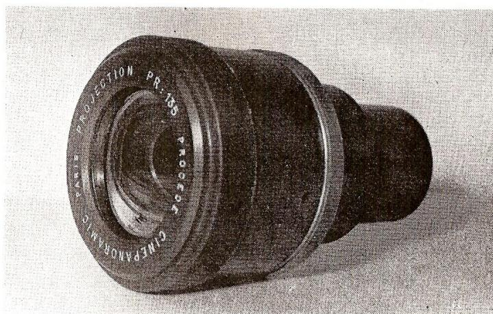
Les derniers modèles d'objectifs de projection Cinépanoramic comportent désormais une bague spéciale de réglage qui permet le changement rapide d'objectif en cours de séance, sans mise au point, pour projection de films normaux. Ce nouveau modèle, grâce aux alliages spéciaux de la monture, est allégé de plus de 900 grammes.
