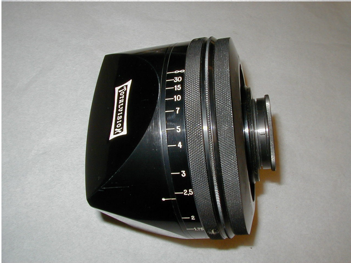
Figures 1.83. : anamorphoseur de prise de vues à prismes Totalvision n° 100 (prototype) au taux de 1,5 pour film 24 x 36 mm de type VistaVision ; exemplaire conservé par la Collection des Appareils de la Cinémathèque française, clichés personnels
