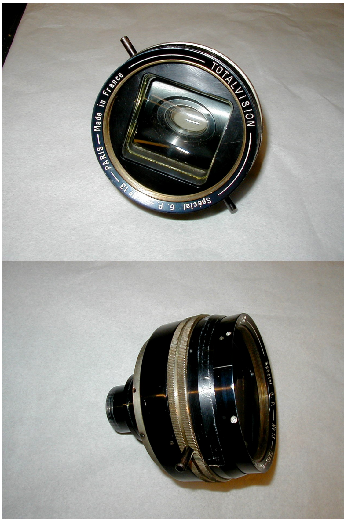
Figures 1.82.c : anamorphoser de prise de vues « spécial Gros Plans » n° 13 Totalvision, conservé par la Collection des Appareils de la Cinémathèque française, clichés personnels
