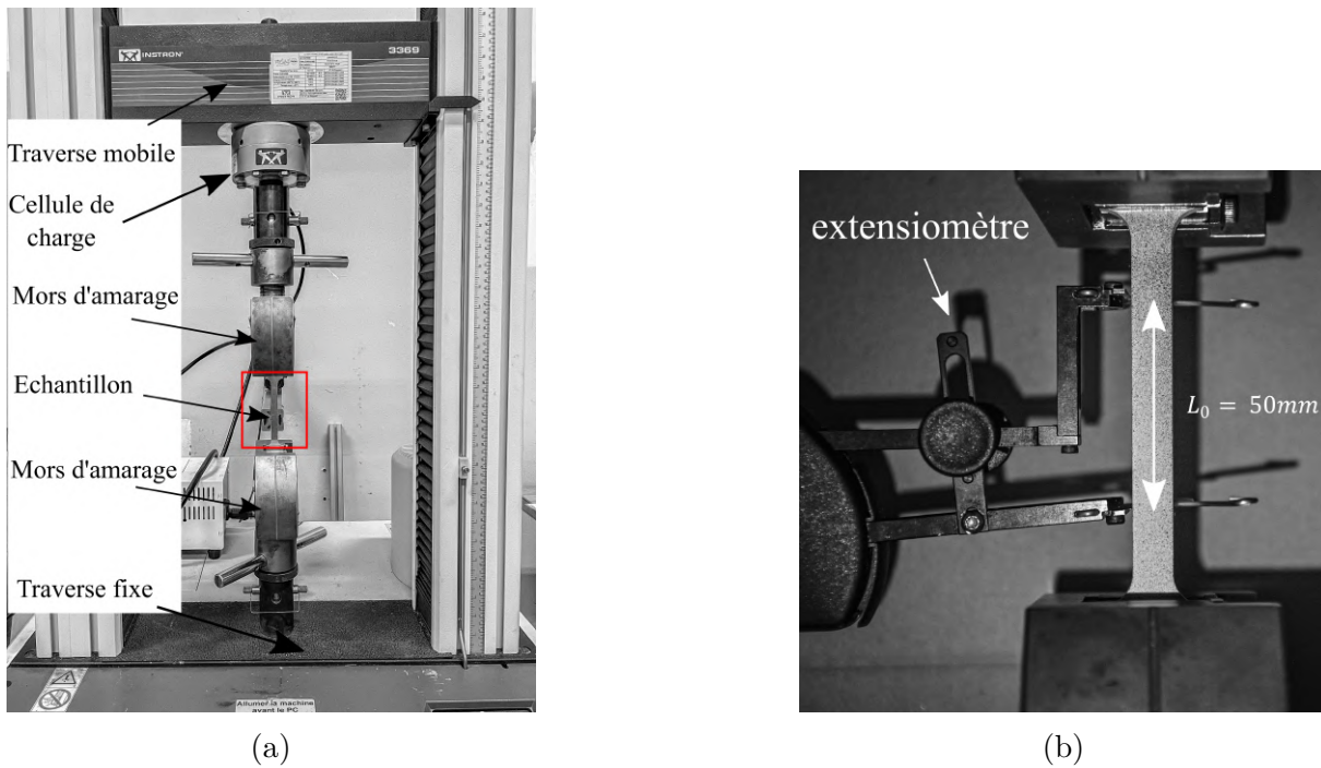
FIGURE 2.6 – Montage de l'extensomètre sur un système d'essai universel INSTRON 50 kN
