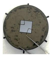
Figure 3.7 : Photo d'un substrat  $Si(111)p_{++}$  fixé sur le molyblock à l'aide de deux cavaliers avant introduction sous UHV.
