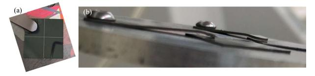
Figure 5.12 : Image de l'échantillon de nanofils prédécoupé au laser et fixé sur le support avant dépôt de Sb<sub>2</sub>S<sub>3</sub> (a). Image en vue de profil du même échantillon montrant que la languette de fixation protège une zone de l'échantillon du dépôt (b).
