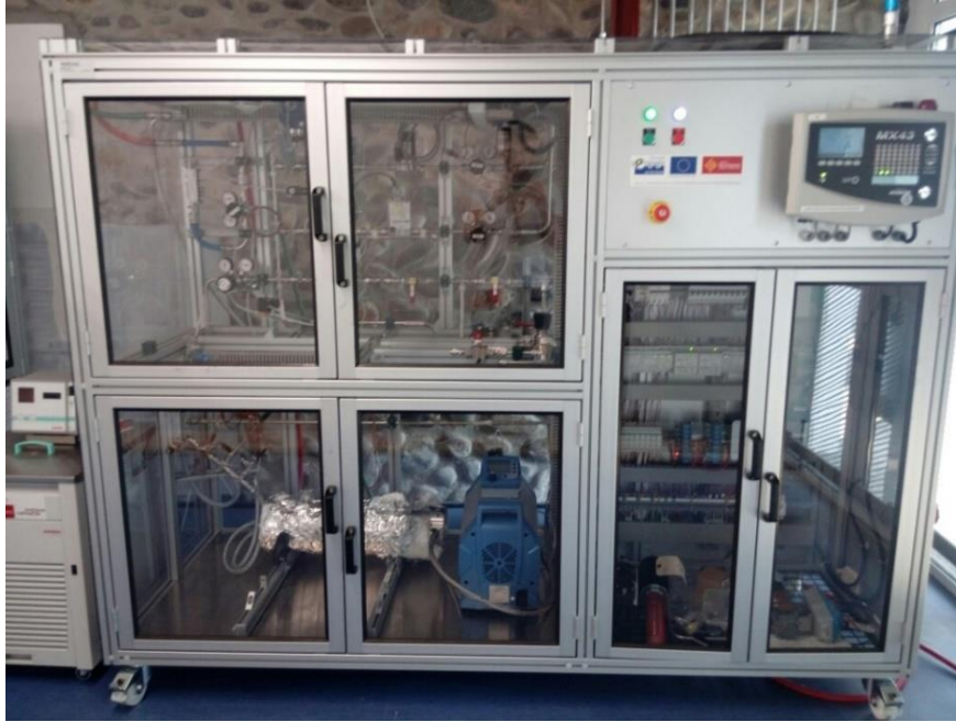
Figure 4.19 : Photo du banc d'essai de caractérisation d'un réservoir hydrure
