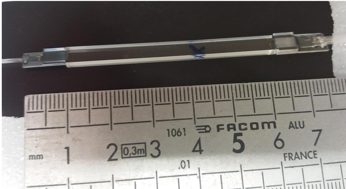
**FIGURE 2.12** – Photographie de la puce Y testée sur le banc de test de FIRSTv2 à Meudon.
