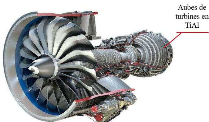
Figure 1 : Vue simplifiée du moteur Leap développé par Safran
