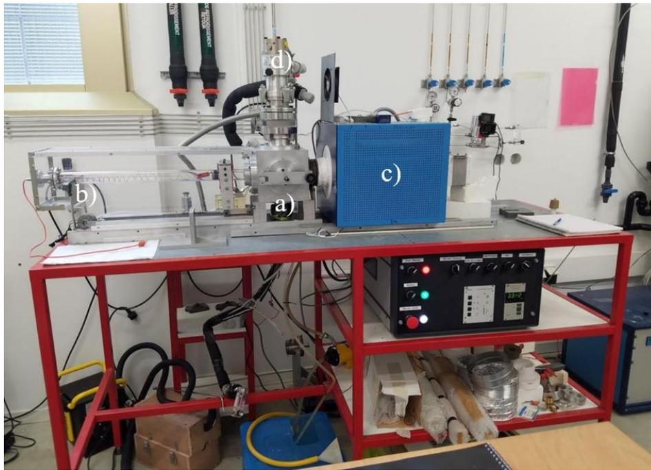
Figure 2. 6 : Photographie du four utilisé pour les traitements thermiques
