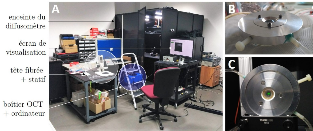
Figure V.5 – Installation expérimentale au CERIMED de Marseille. (A) Système SD-OCT OQ Labscope 2.0 installé à proximité du diffusomètre. (B,C) Porte-échantillon cornéen dédié à des mesures sous pression en transmission : face antérieure (B) et face postérieure (C).
