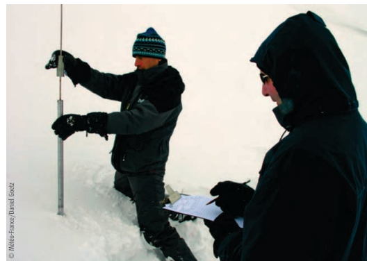
FIGURE 1.6 – Exemple de mesure réalisée sur le manteau neigeux. La sonde par battage est un instrument de référence pour la mesure de la résistance à l'enfoncement.
