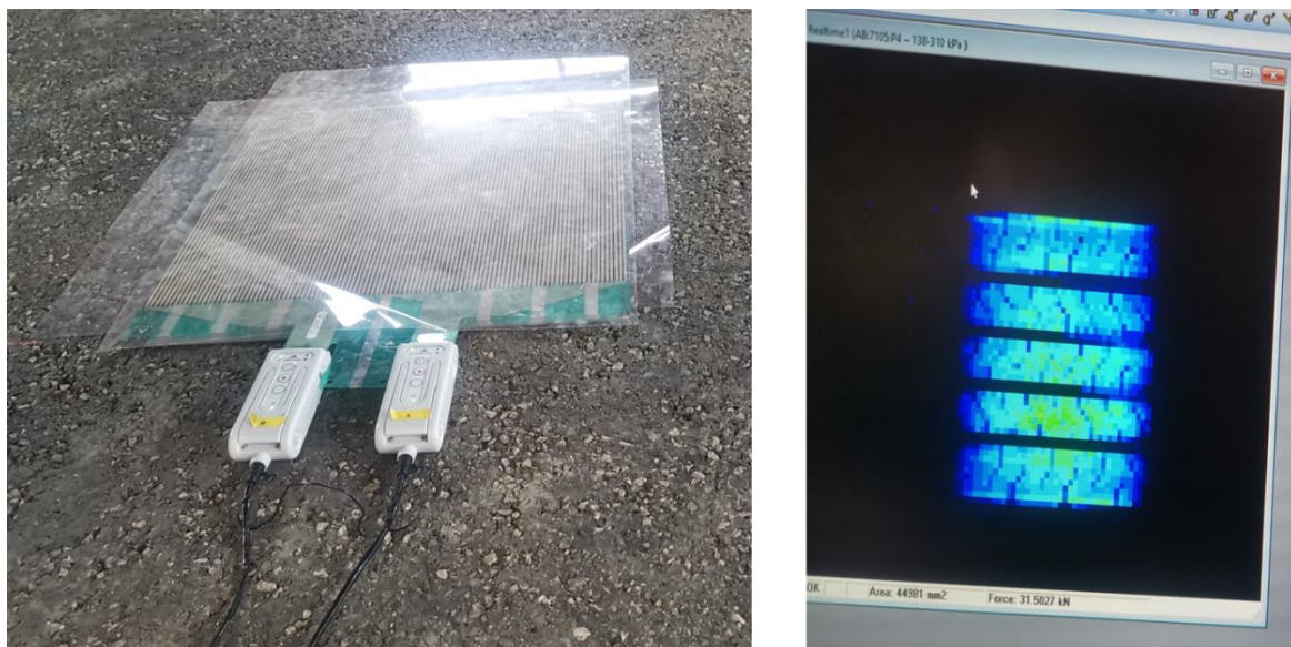
Figure 123 Calibrage de la charge à l'aide du TekScan
