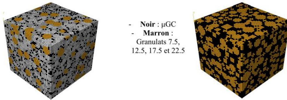
Figure 36 VER 3D de  $\mu\text{GC}$  (gauche) et VER 3D de GC (droite) dans Abaqus (Sow, 2018)
