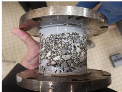
Figure 79 Collage sur les plateaux amovibles (après démontage)
