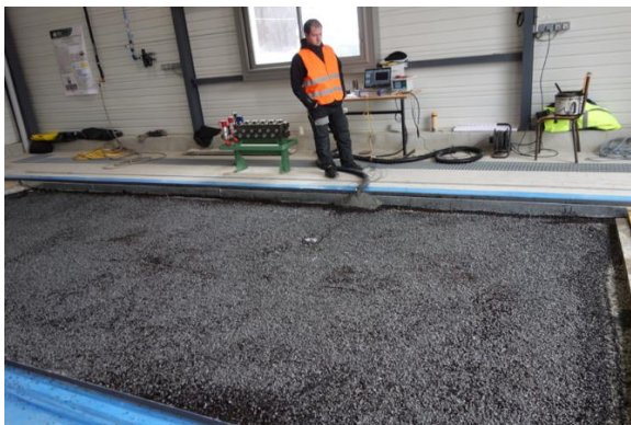
Figure 119 Mise en œuvre de la couche de GB \epsilon + dans la fosse
