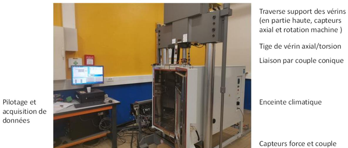
Figure 72 Presse MTS au laboratoire GC2D
