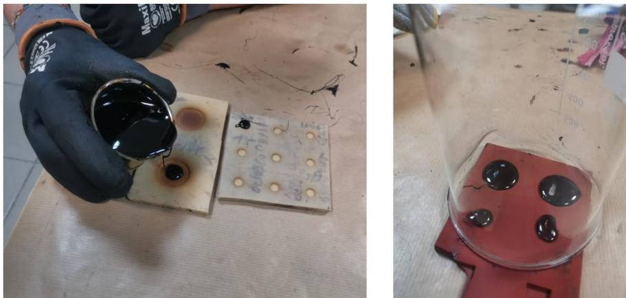
Figure 48 Coulage et stockage des échantillons de liant
