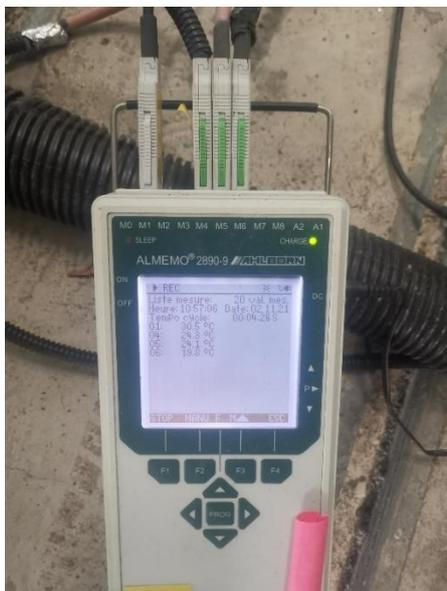
Figure 127 Système d'acquisition des températures ALMEMO 2890-9
