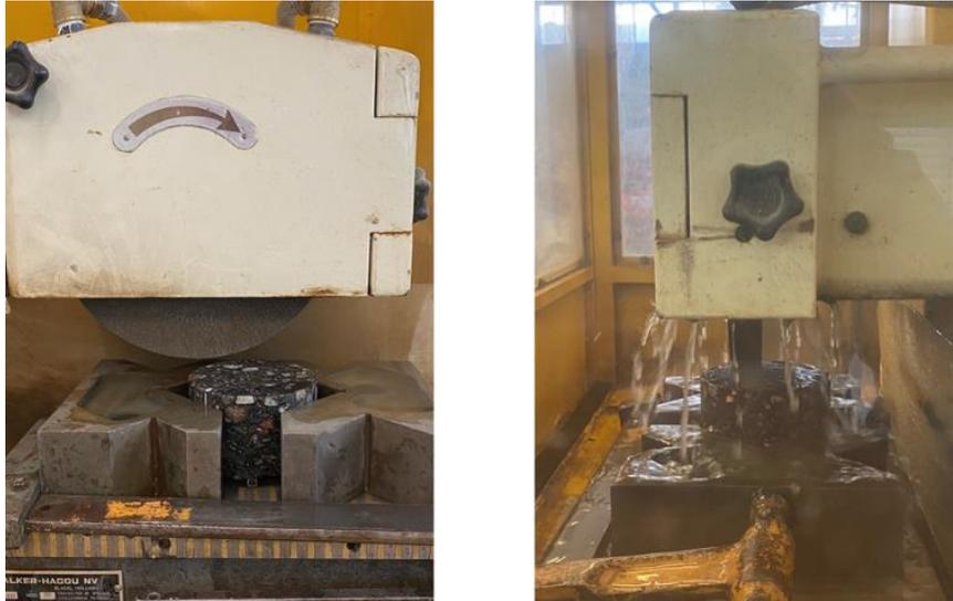
Figure 76 Rectification des éprouvettes (phase 1 et 2)
