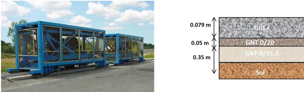
Figure 169 Machine Fabac (gauche) et structure testée (droite)
