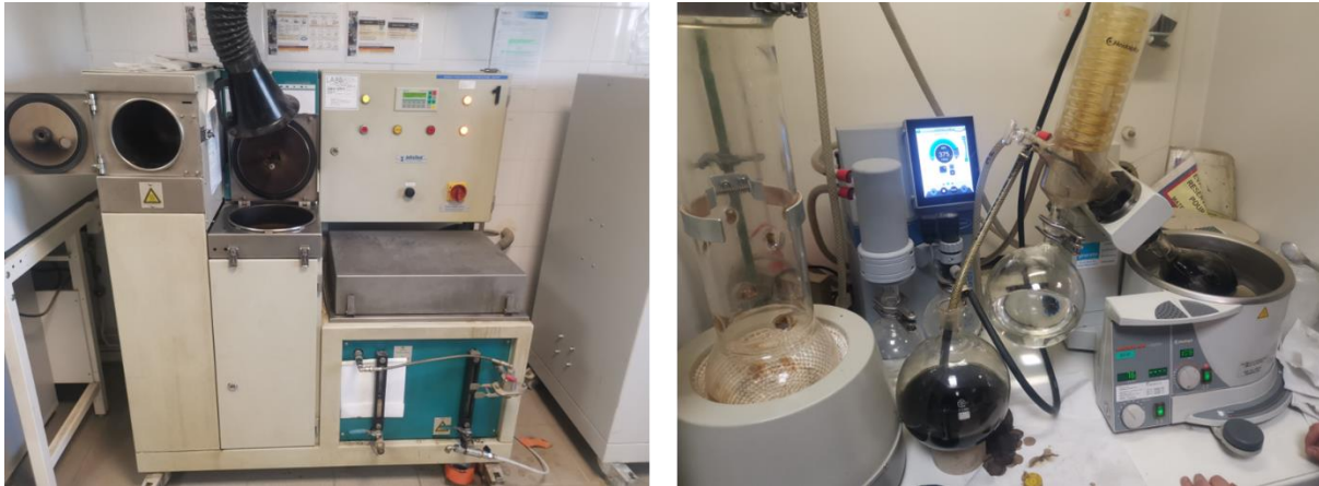
Figure 41 L'Asphaltanalysator (gauche) et l'évaporateur rotatif (droite)
