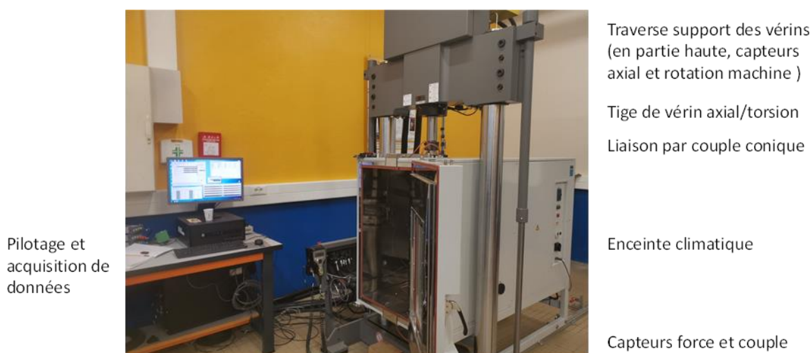
Figure 72 Presse MTS au laboratoire GC2D
