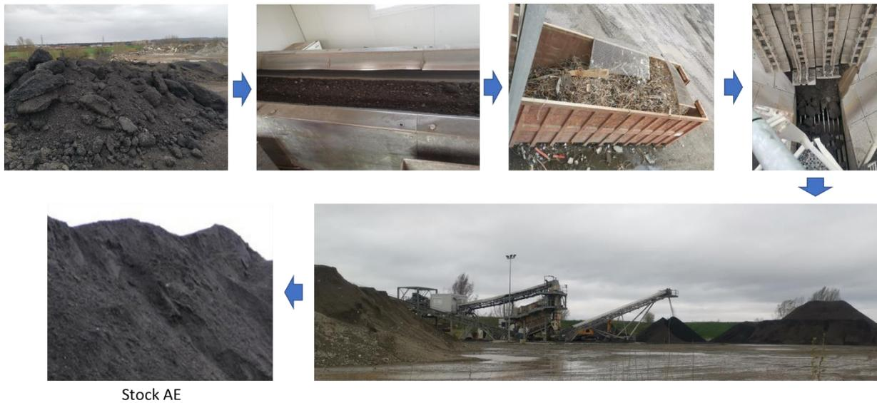
Figure 14 Production des AE (photos prises lors de la visite à la centrale Ambromat pour le traitement des déchets à Toulouse, 2020)
