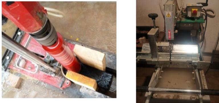
Figure 74 Carottage et sciage des éprouvettes
