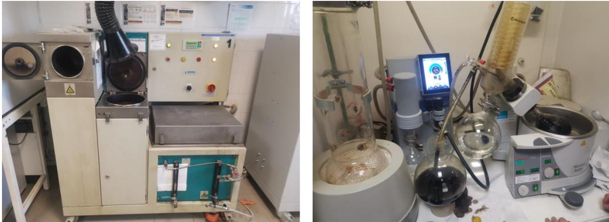
Figure 41 L'Asphaltanalysator (gauche) et l'évaporateur rotatif (droite)
