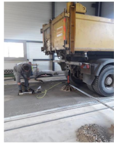
Figure 118 Remplissage de la fosse (gauche) et l'essai de plaque (droite)
