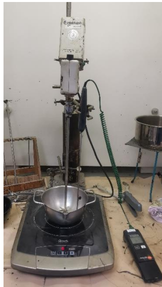
Figure 42 Dispositif de malaxage : l'agitateur à hélices et la plaque chauffante
