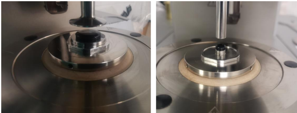
Figure 49 Mise en place des échantillons sur le rhéomètre en utilisant les géométries PP25 (gauche) et PP8 (droite)
