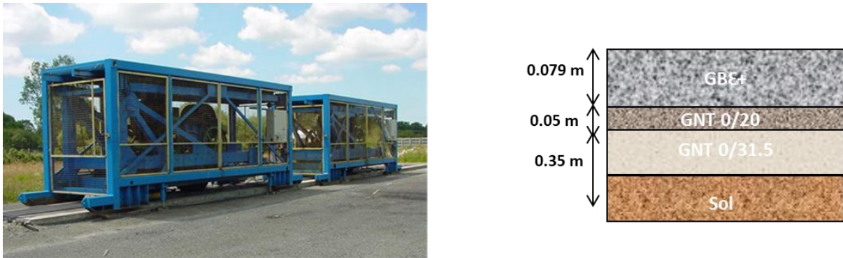
Figure 169 Machine Fabac (gauche) et structure testée (droite)
