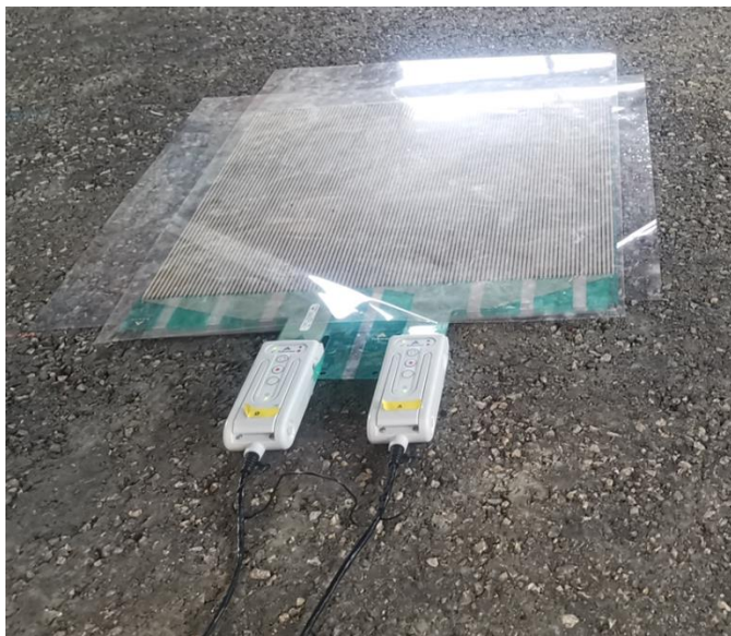
Figure 123 Calibrage de la charge à l'aide du TekScan
