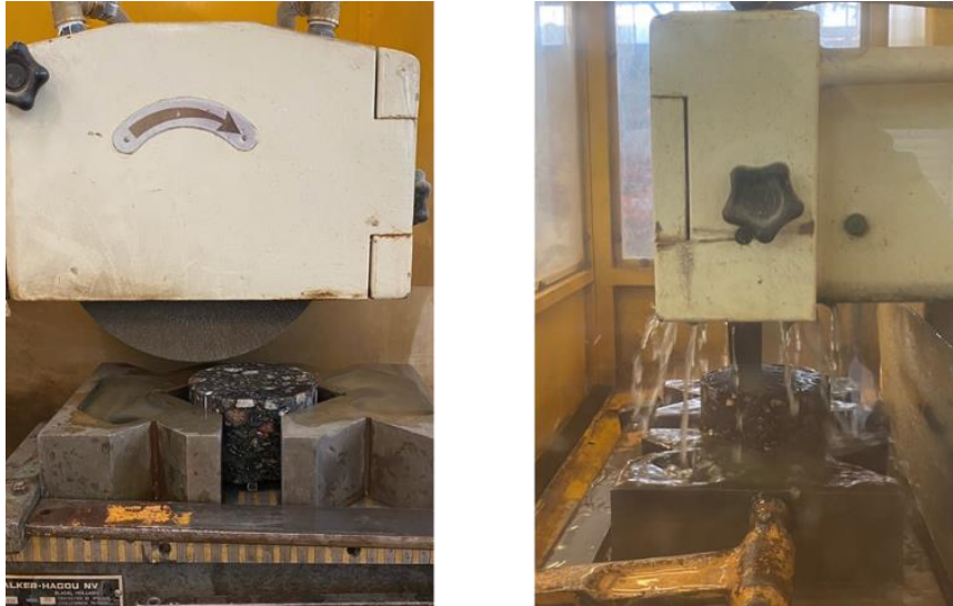
Figure 76 Rectification des éprouvettes (phase 1 et 2)
