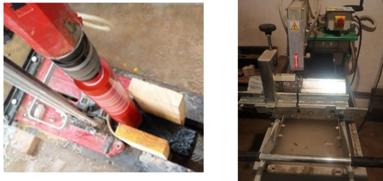
Figure 74 Carottage et sciage des éprouvettes
