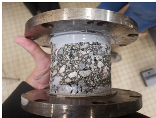
Figure 79 Collage sur les plateaux amovibles (après démontage)
