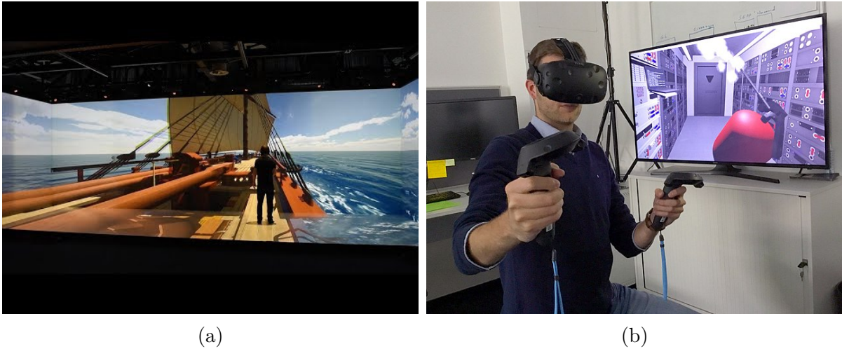
FIGURE A.1 – (a) Exemple de CAVE nommé Immersia situé à Rennes, France. (b) Exemple d’un visiocasque/HMD. L’utilisateur est un astronaute s’entraînant en RV à éteindre un feu dans un habitat lunaire. De ESA, CC BY-SA IGO 3.0.
