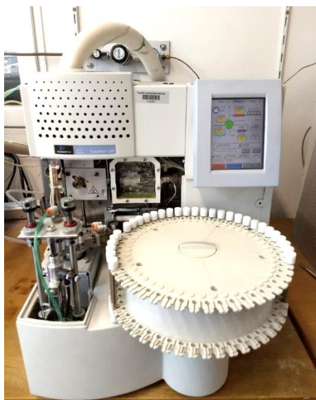
Figure 15 : Photo de l'ATD utilisé au laboratoire.
