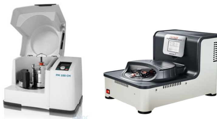
Figure 7 : Appareils utilisés pour les essais de mécanosynthèse. Gauche : RETSCH PM100. Droite : FRITSCH Pulverisette 7.
