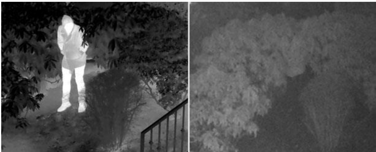
Figure 11: Comparaison entre la vision par une caméra infrarouge (gauche), et par une caméra dans le visible (droite).
