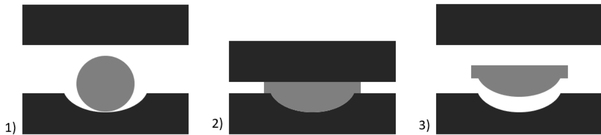
Figure 22 : Représentation schématique du principe de moulage. 1 : Mise de la préforme dans le moule et chauffe. 2 : Application de la pression et refroidissement. 3 : Retrait de la pression et récupération de la lentille.
