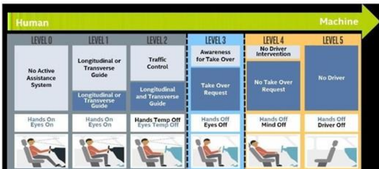
Figure 23 : Description des niveaux d'autonomie de la conduite autonome.
