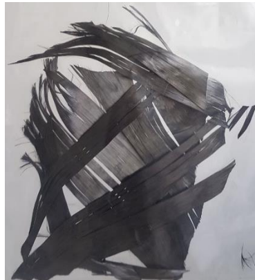
Figure 3-11: Photographie d'une plaque epoxy/fibre de carbone 100 x 130 x 2,4 mm 3 recyclée
