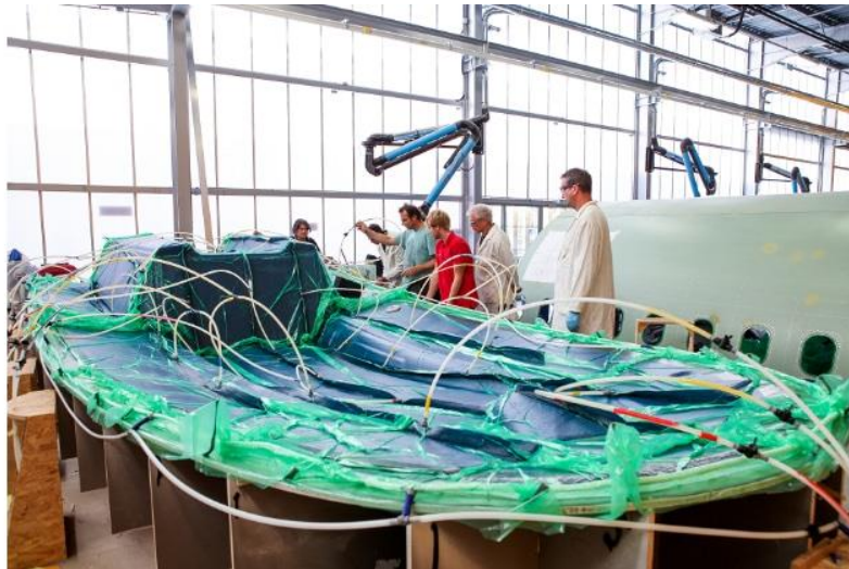
Figure 1-6: Infusion du Pont du voilier Monocoque Mini 6.50 d'ARKEMA en 2016
