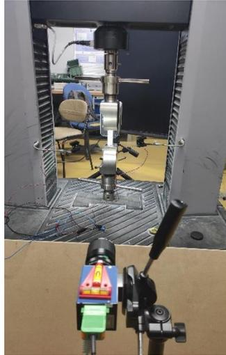
Figure 2-22: Photo du Montage de traction
