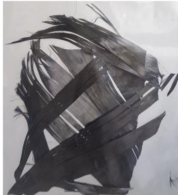
Figure 3-11: Photographie d'une plaque epoxy/fibre de carbone 100 x 130 x 2,4 mm<sup>3</sup> recyclée
