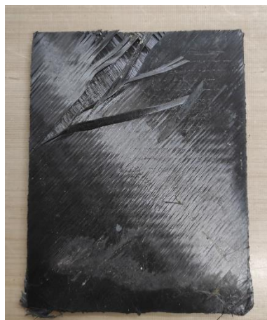
Figure 3-10: Plaque CBX600/matrice époxy recyclée 5h (% de résine résiduelle =25%)
