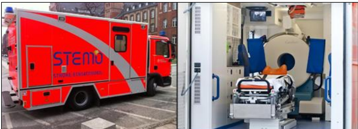
Figure 14 : L'ambulance du projet STEMO. A droite de l'image, le scanner encéphalique embarqué à l'intérieur de l'ambulance.
