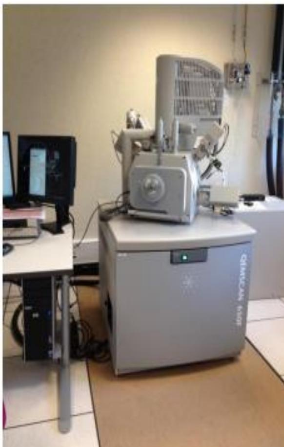
Figure III-7 : Photographie du FEI QEMSCAN 650F
