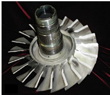
(c) Réparation d'aubes de turbine [148]
