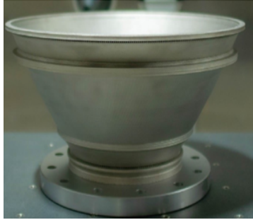
(a) Buse de propulsion à canaux intégrés [66]
