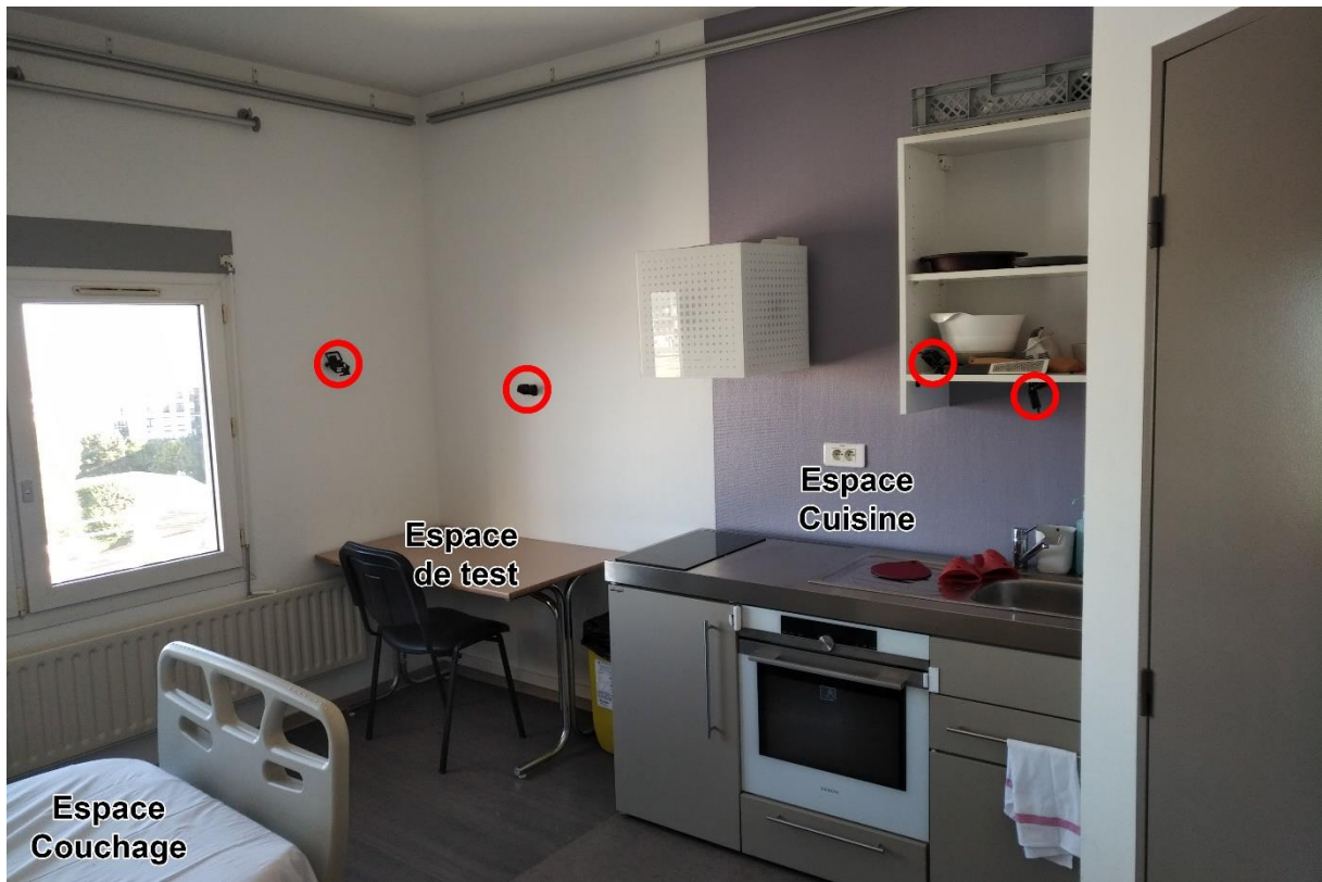
Figure 1 - Vue d'ensemble de l'habitat SmartFlat avec l'espace de couchage, l'espace cuisine et l'espace de test équipé de support pour caméra GoPro® (cerclés en rouges)
