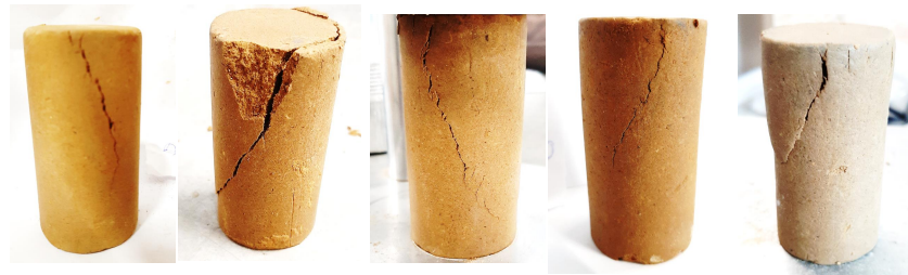
FIGURE 6.4 – Illustration de la rupture en cisaillement des échantillons non gelés.
