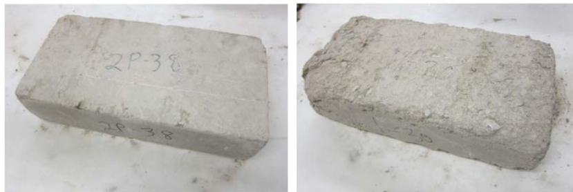
FIGURE 2.21 – Impact de l'absorption d'eau par capillarité dans le processus de dégradations au gel-dégel de BTC stabilisés : échantillon sans absorption d'eau (à gauche) et avec absorption d'eau (à droite), d'après [212].
