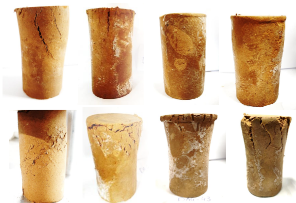
FIGURE 6.9 – Illustration des différents modes de rupture des échantillons gelés.
