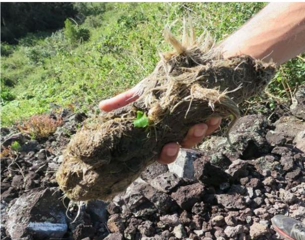
Figure 88: Bouchon formé par des végétaux extirpé de la conduite d'un captage, Roche-Plate, Lallemand J., 2019
