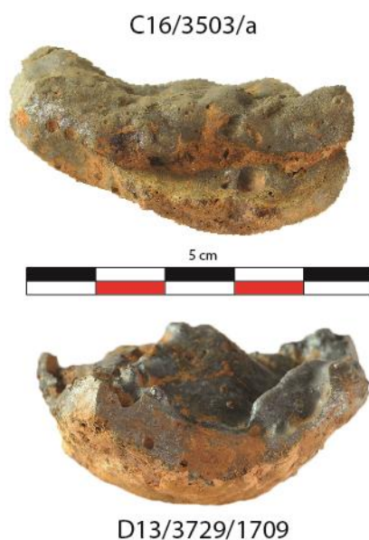
Figure 101 : Exemples de scories associées à une couche résiduelle de céramique ou de sol dans leur partie inférieure.
