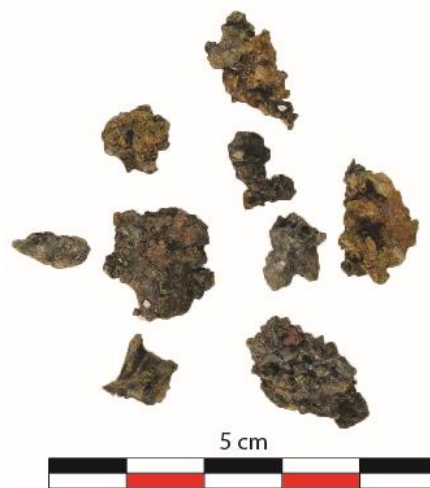
Figure 188 : Minéraux partiellement réagis issus la réduction 3 avec une granulométrie entre 3,5 et 2,5 mm.
