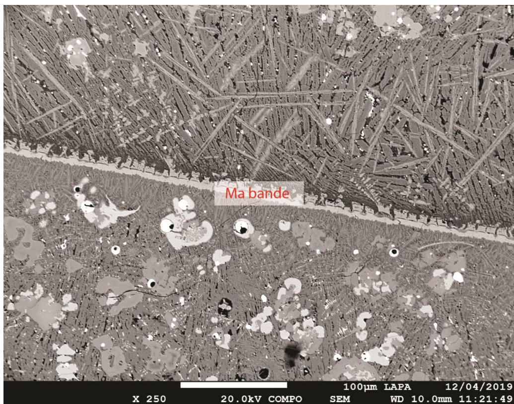
Figure 119 : Image BSE (x300) montrant la présence de magnétite en bandes dans l'échantillon PBL/B14/1/2/7002/b.
