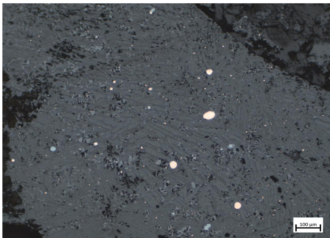
Figure 90 : Micrographie d'une scorie adhérente au creuset de TNN (DF/1-B/3/113). Il s'agit du seul exemple de scorie de type fayalitique pour TNN.
