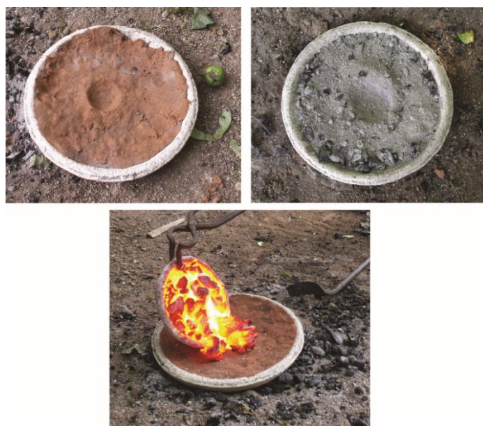
Figure 182 : Les différents contenants utilisés pour la coulée du mélange. En haut à gauche, le sable de fonderie et en haut à droite, les cendres. En bas : exemple de coulée après une réduction.
