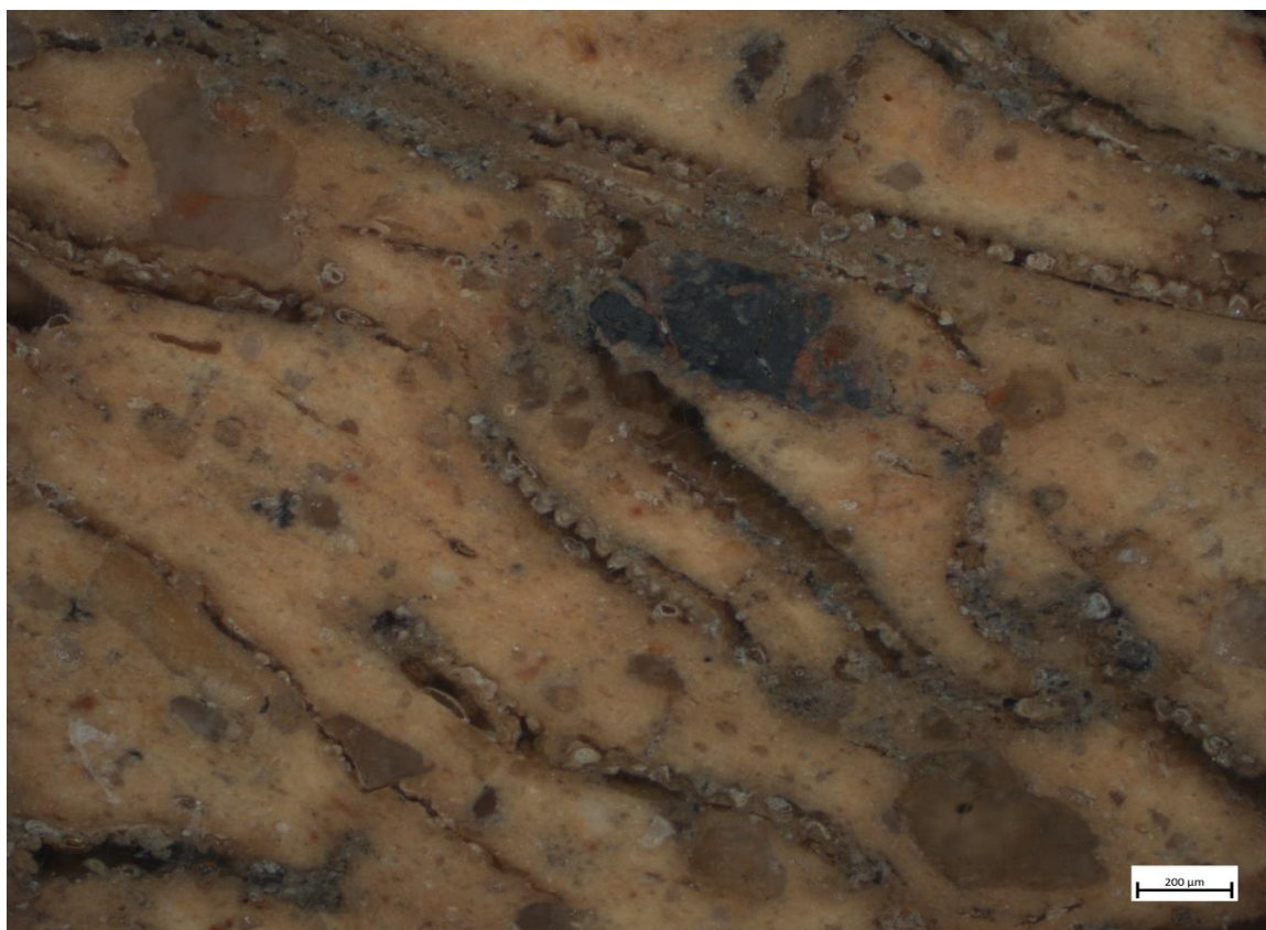
Figure 68: En haut (PBL/C14/2/3/7217), on identifie la présence d'inclusions (blanches) correspondant à du rutile dans la pâte, ainsi que des grains de quartz de plus petites dimensions avec une interface de dissolution. En bas (PBL/D13/2/1/3706/a), image en champ noir, de l'extérieur d'un creuset ayant conservé ses qualités en microscopie optique à la suite de la chauffe. On identifie également la présence du dégraissant organique.
