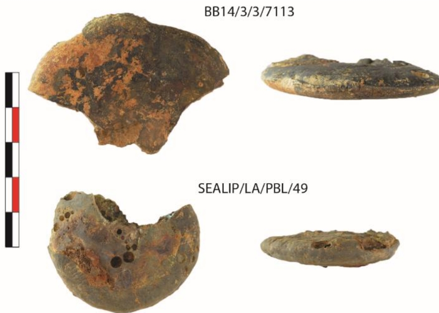
Figure 154 : Les lingots avec couches multiples de cuivre métallique, matte et/ou scorie. Échelle = 5 cm.
