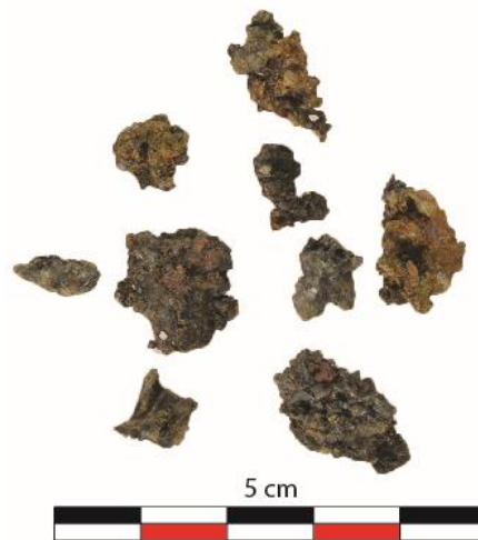
Figure 188 : Minéraux partiellement réagis issus la réduction 3 avec une granulométrie entre 3,5 et 2,5 mm.
