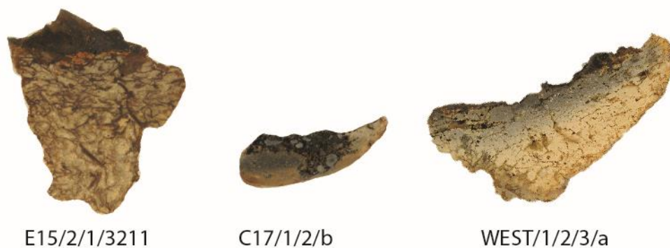
Figure 60 : Exemples de sections polies montrant la porosité liée à la présence du dégraissant organique et le gradient thermique.
