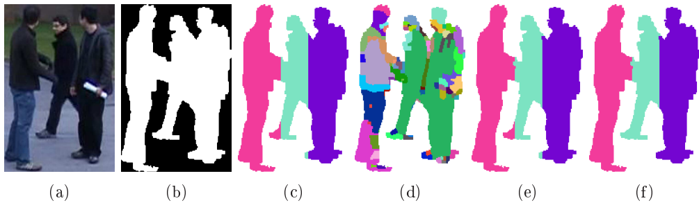
FIGURE 1.26 – Séparation des personnes : (a) image originale, (b) Blob , (c) séparation verticale, (d) segmentation en régions, (e) raffinement de la séparation, (f) post-traitement.
