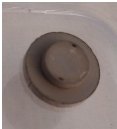
Figure III-8 : Photo d'un fritté à bord dense en platine réalisé par frittage flash au laboratoire CIRIMAT de 13 mm de diamètre
