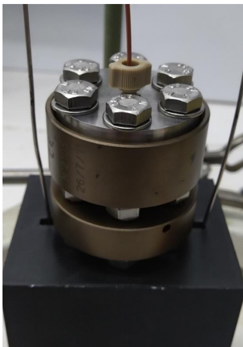
Figure III-6 : Photo du montage de réparation de l'obturateur de la boucle SolO par l'utilisation du Diabolo
