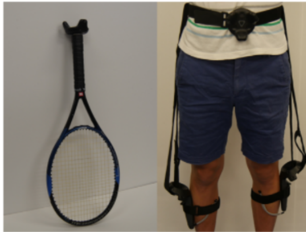
FIGURE 2.9 – Matériel d'analyse de mouvement fixé à une raquette de tennis (à gauche) et au corps d'un participant (à droite) (SAITO et al. , 2018)
