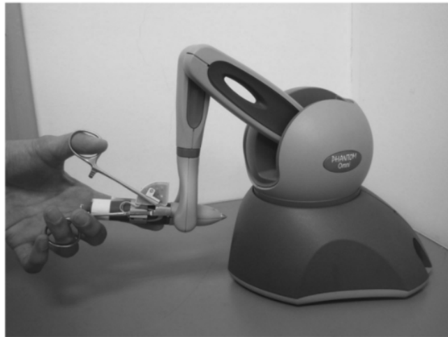
FIGURE 2.2 – Exemple de dispositif haptique : Geomatic Touch . Il permet de capturer les coordonnées (x, y, z) et la direction du stylet. De plus, il peut générer une force s'opposant à la main de l'utilisateur, permettant la simulation du toucher et des interactions avec des objets virtuels. (MIKI et al. , 2016)
