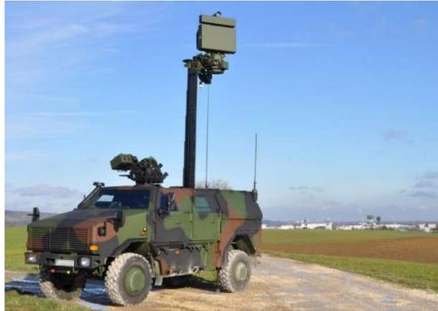
Figure 1 : Photographie d'un véhicule de l'armée de terre utilisant un radar à balayage giratoire.
