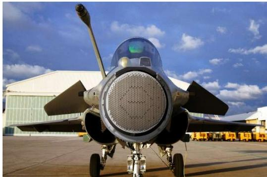
Figure 6 : Photographie du radar RBE2 sur le Rafale.
